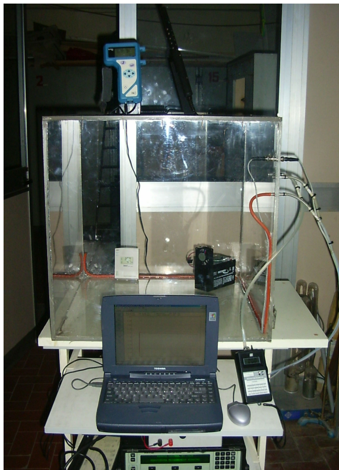
Figura 4.3 - Camera realizzata per la prova di tenuta all'aria.
