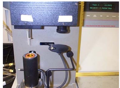
Figura 5 - (Fornace TGA TA2950)
