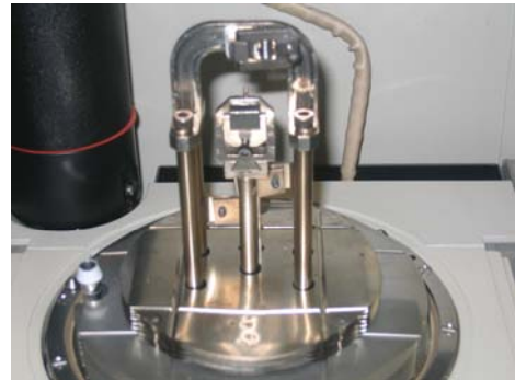
Figura 9 - (DMA TA2980 – Particolare clamp)
