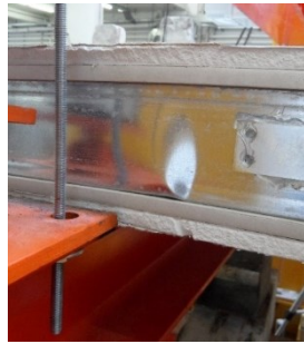
A. Stud local buckling
