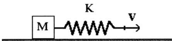
Figura 1. Molla Libera - Blocco di massa M trascinato da una molla di costante elastica k . L'estremità libera della molla si muove a velocità costante v .
