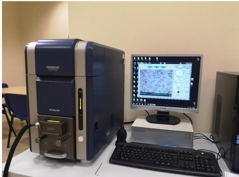
**Figure 5.10.** Hitachi TM3000 Tabletop SEM.
