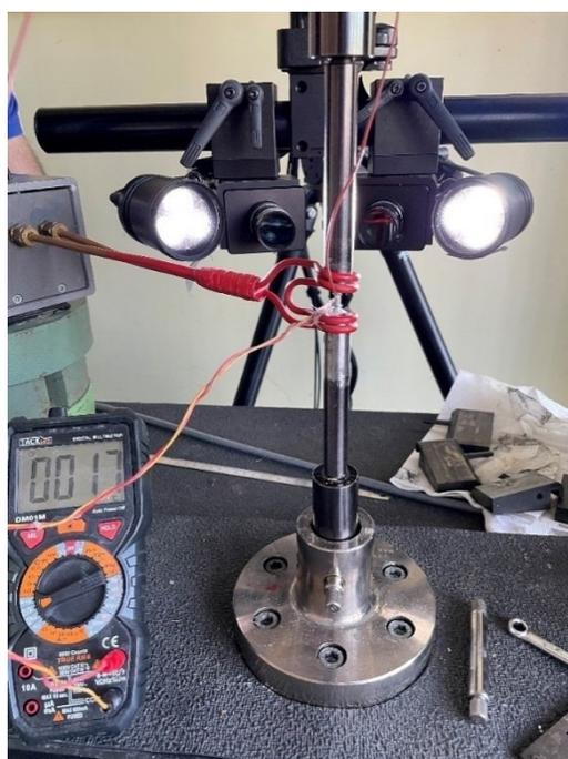
*Figura 5.4-Apparato per test quasi statici di trazione in temperatura*
