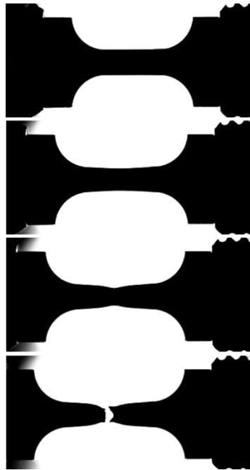
*Figura 5.18-Frames del processo di deformazione e rottura dei provini testati alla barra di Hopkinson*
