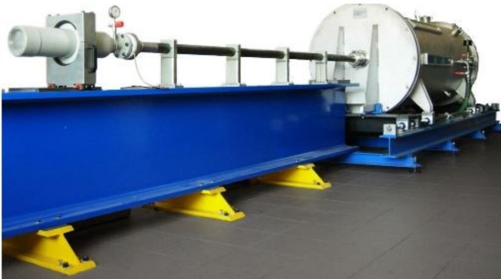
*Figura 6.1-Cannone a gas utilizzato per i test balistici*
