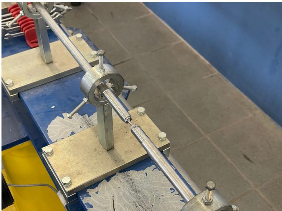
*Figura 5.6-Provino interposto tra barra incidente e trasmittente*
