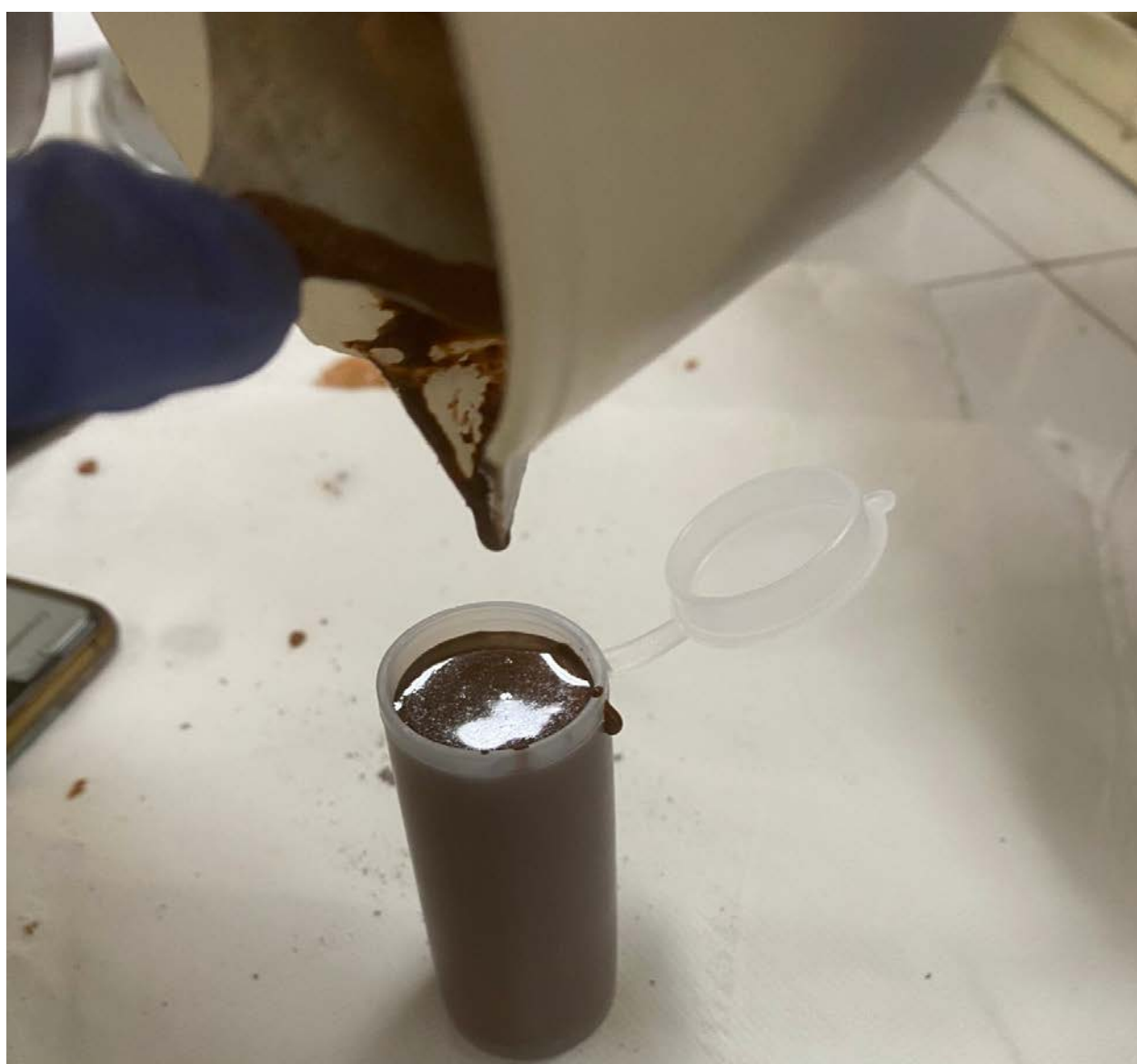
Figure n.118 - Re-geopolymerisation test for sample CP 80
