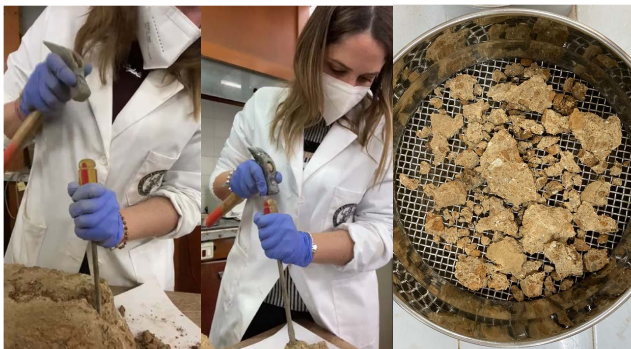
Figure n.14 - Tuff block size reduction activity
