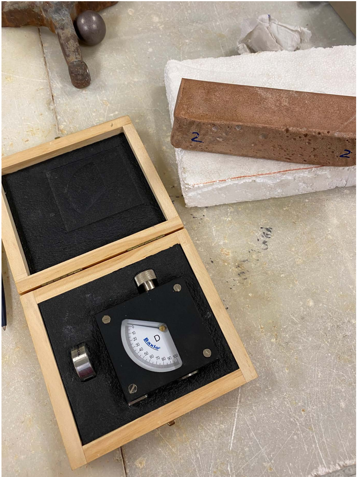
Figure n.113 - Durometer used for the Shore D surface resistance test
