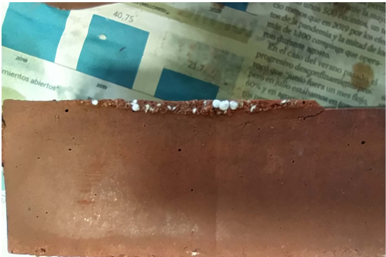
Figure n.141 - Efflorescence detail after the wet chamber cycle
