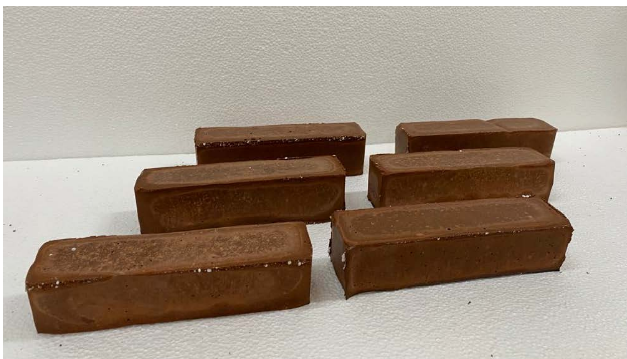
Figure n.127 - CP 80 + 50 samples for durability testing
