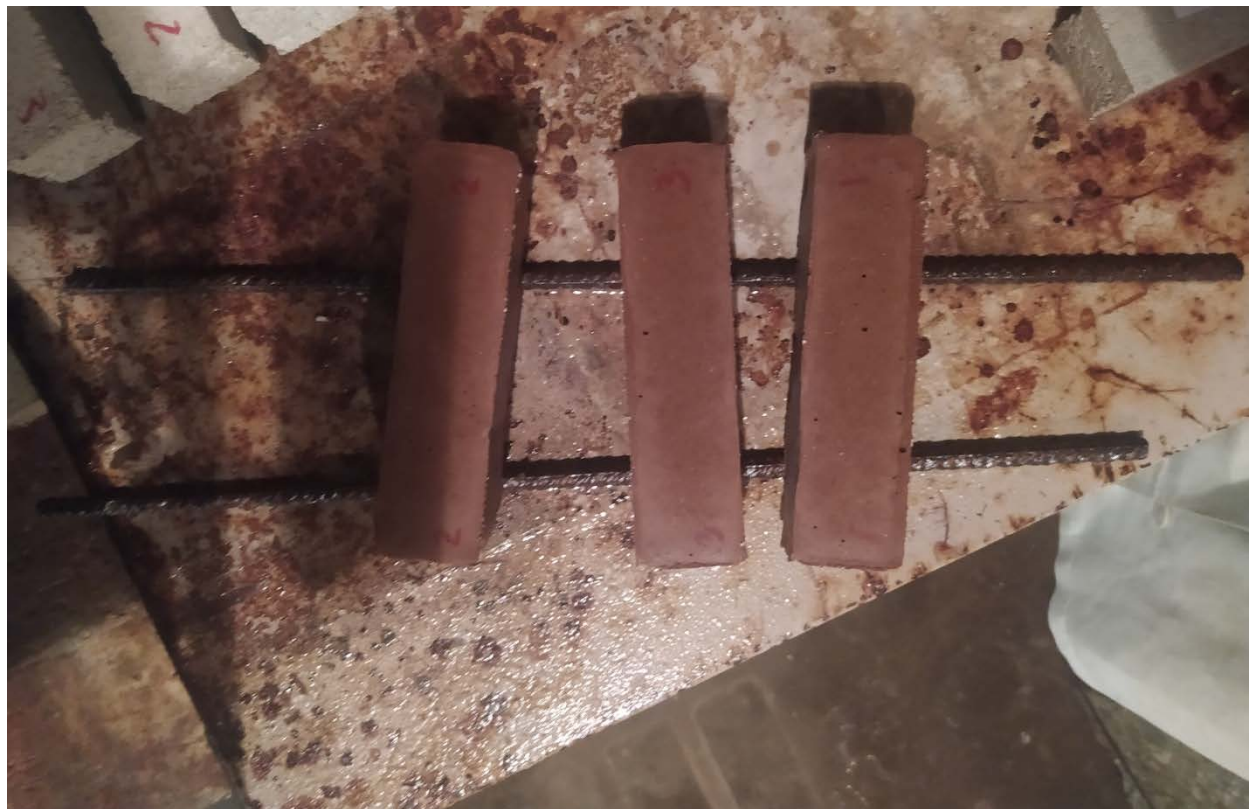
Figure n.139 - Samples CP 80 + 50 inside the wet chamber
