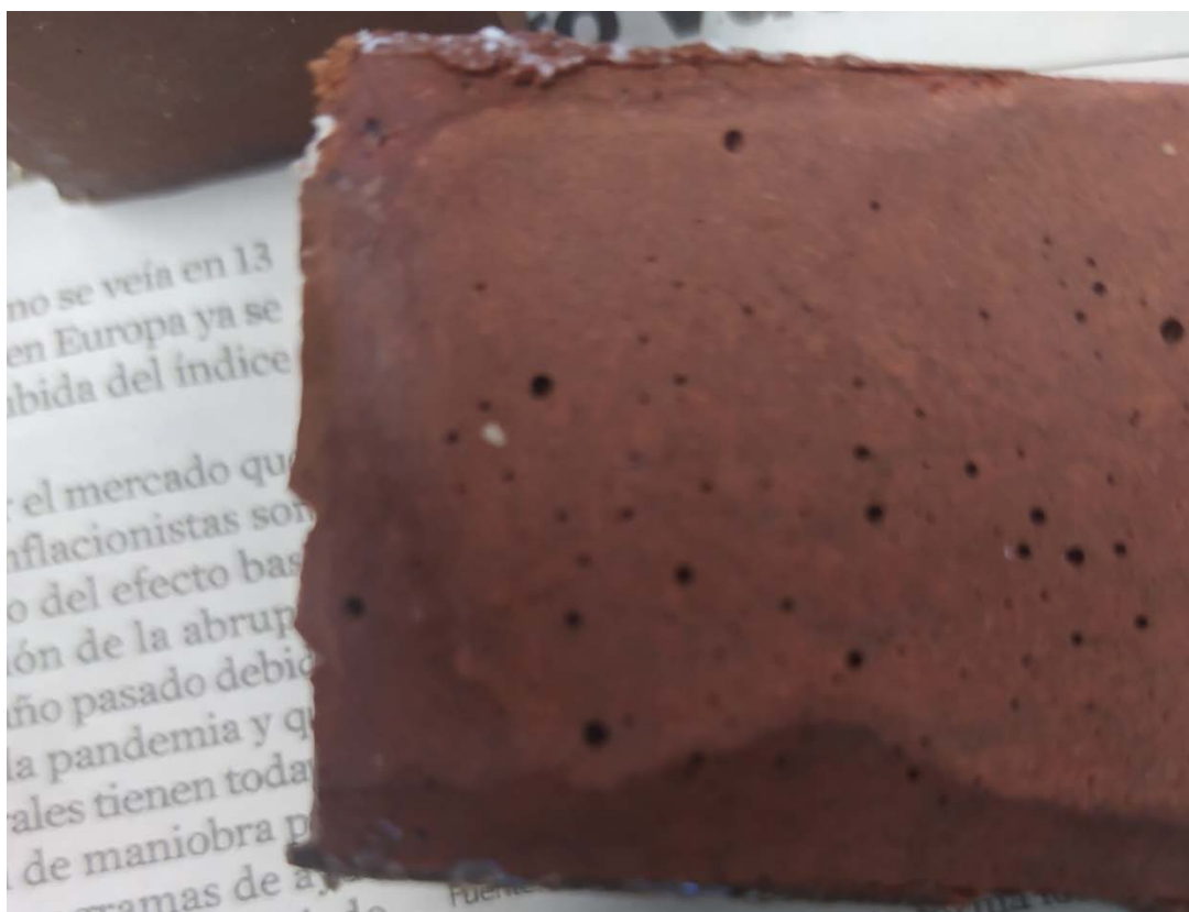
Figure n.131 - Capillary rise after the cycle
