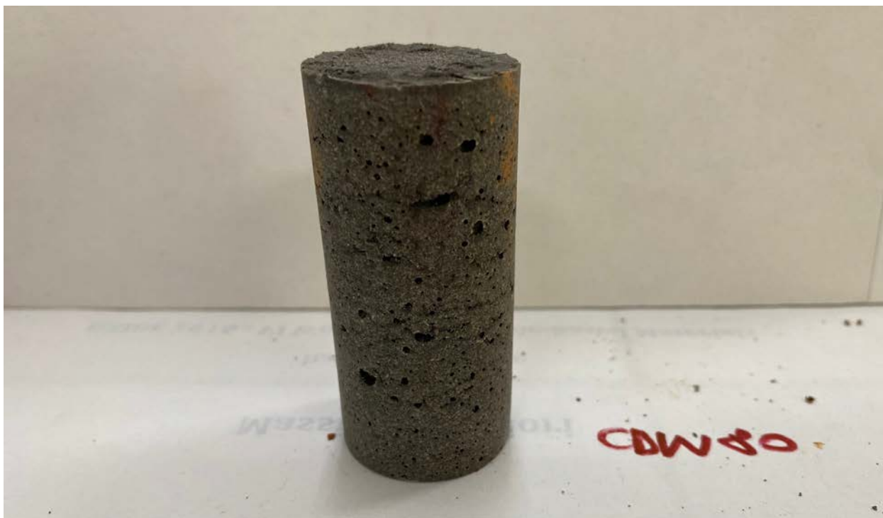
Figure n.123 - Sample C 80 re-geopolymerised
