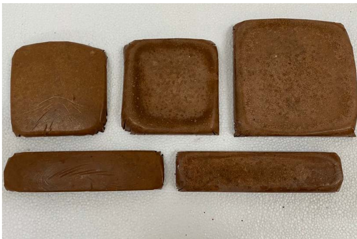
Figure n.155 - Smooth finish tiles to be rectified
