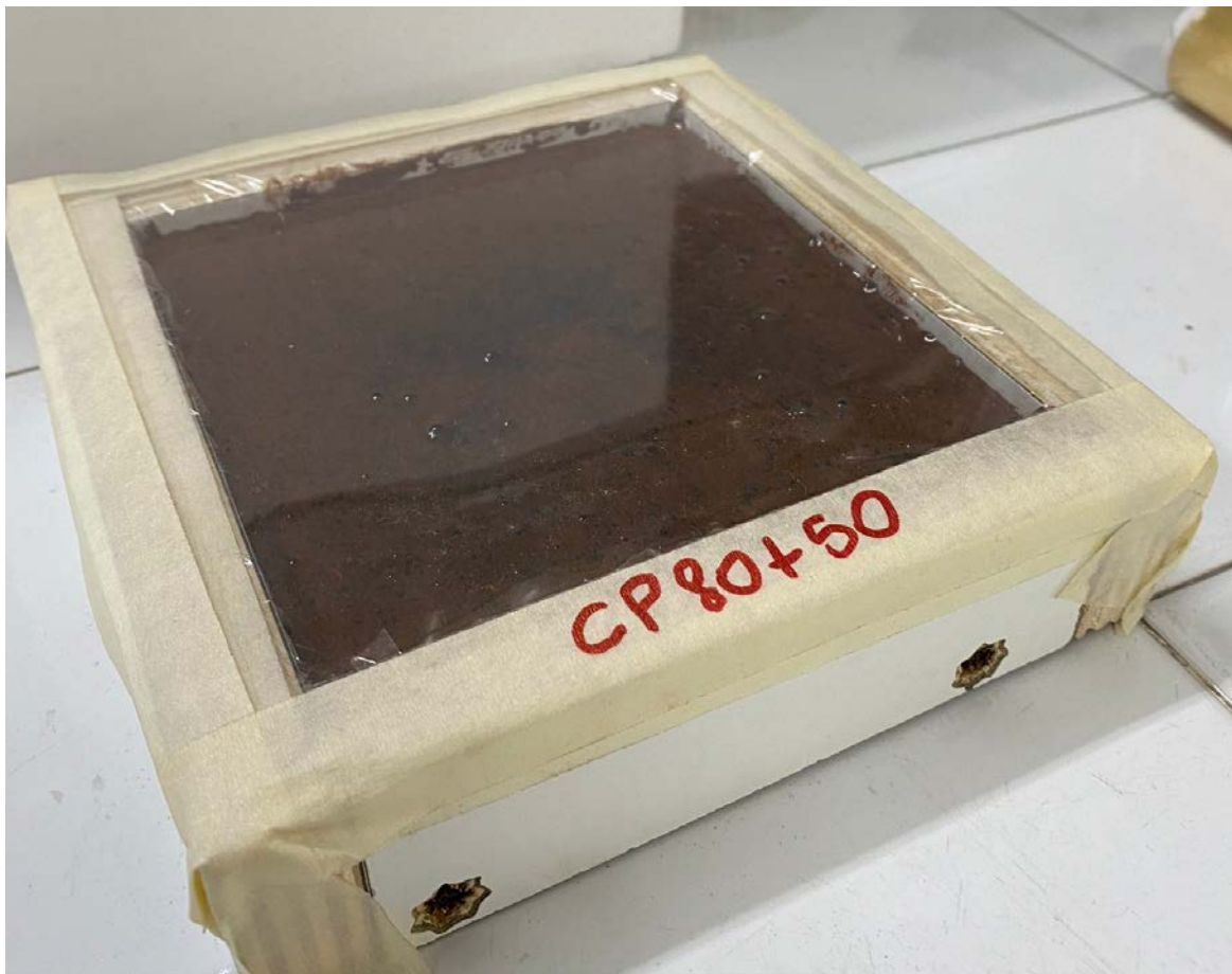
Figure n.153 - Mix poured into the mould
