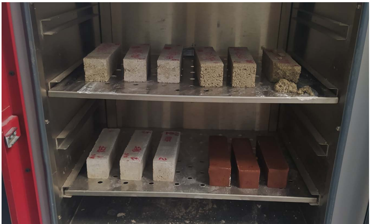
Figure n.133 - Positioning of samples in the oven
