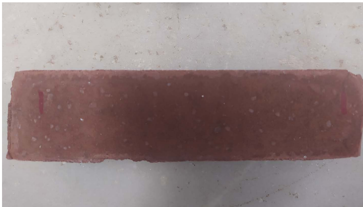
Figure n.129 - Sample 1 CP 80 + 50 matting and efflorescence
