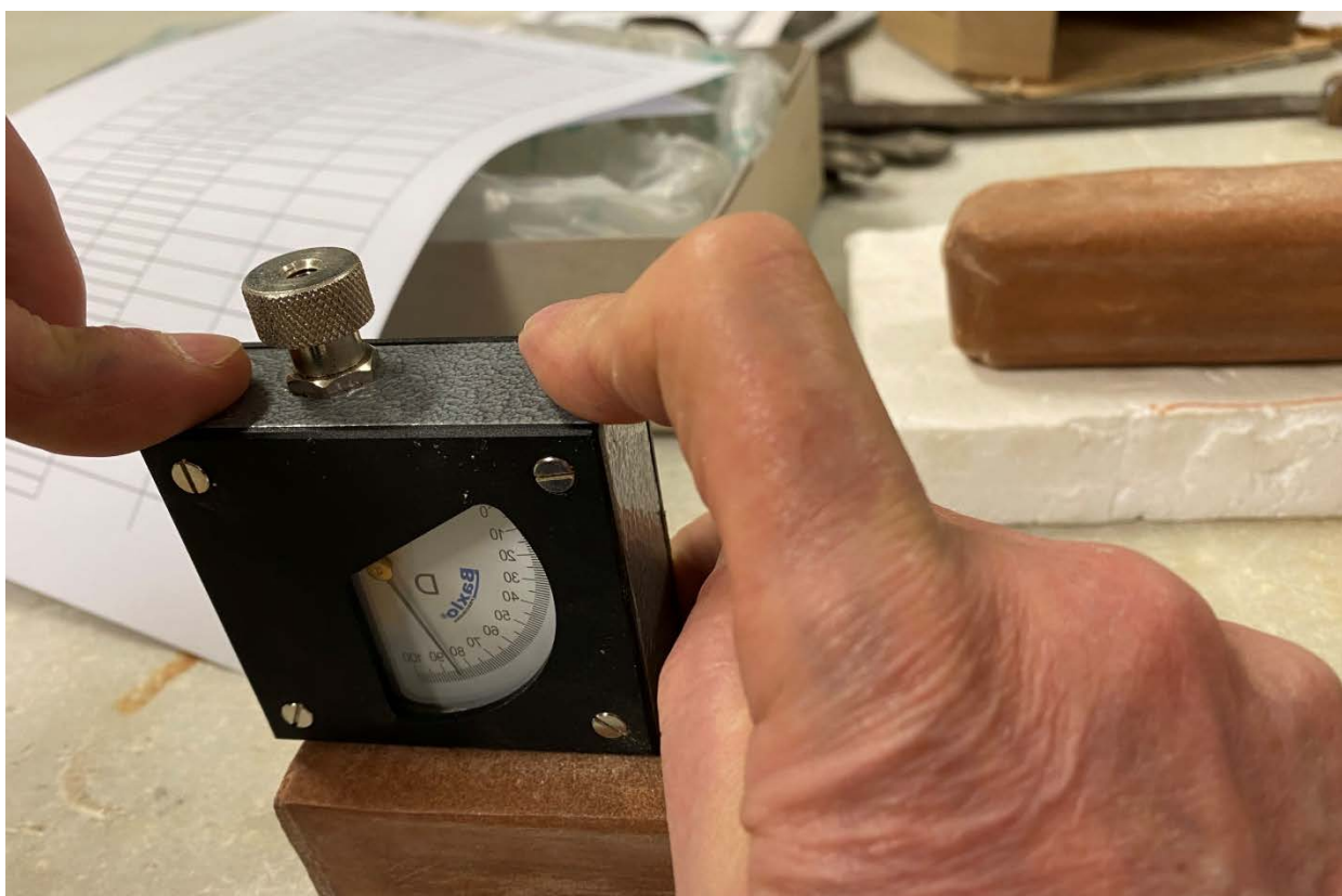
Figure n.115 -Test of Shore D surface resistance
