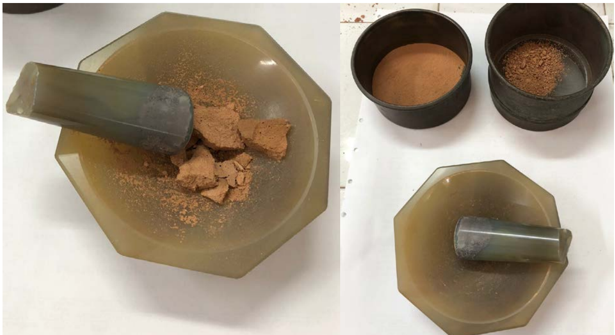
Figure n.104 - Preparation of the test sample (Pycnometer method)
