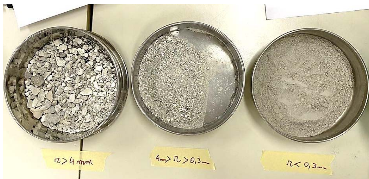
Figure n.17 - Particle size fractions
