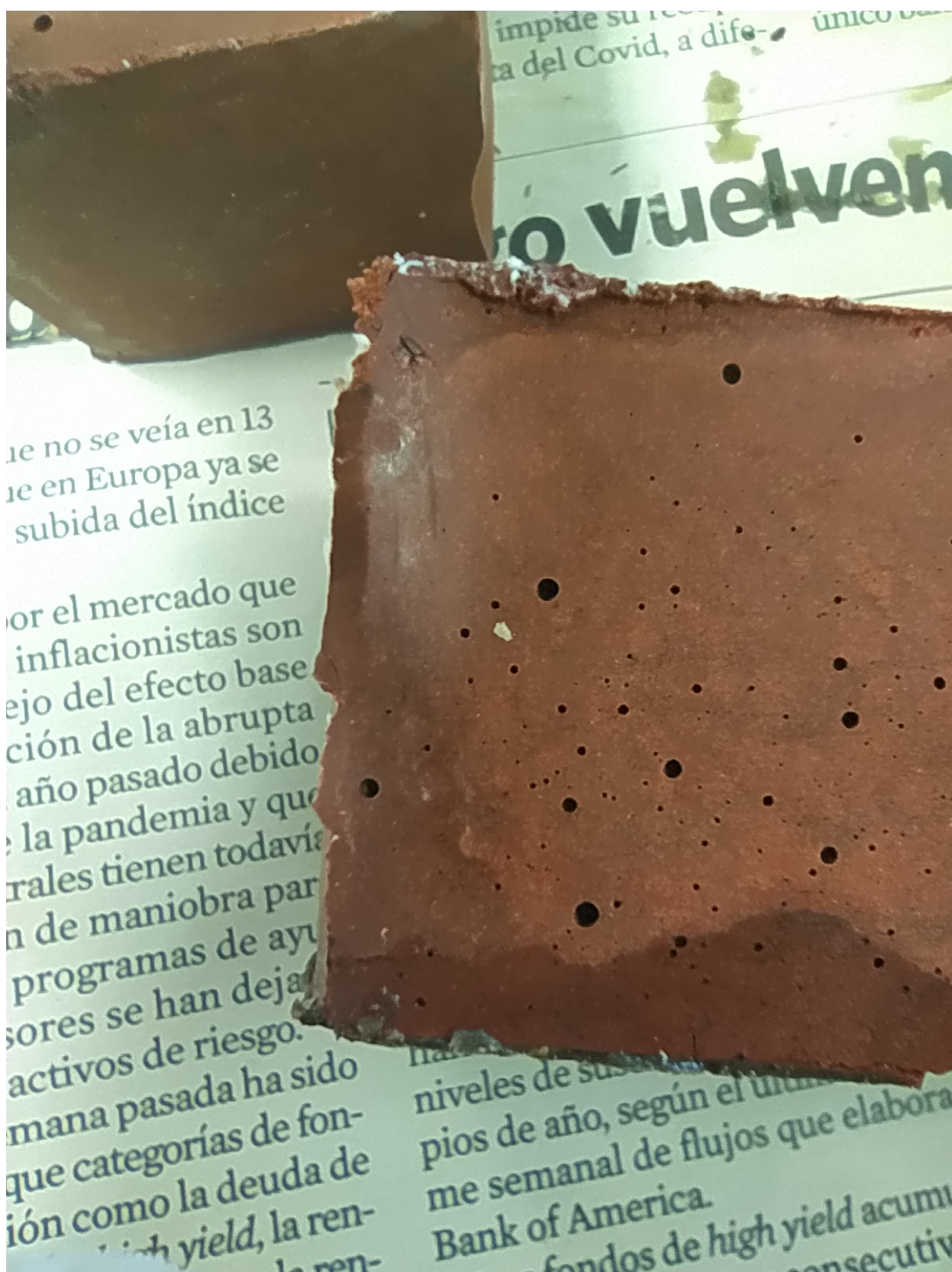
Figure n.138 - Capillary rise of water after immersion
