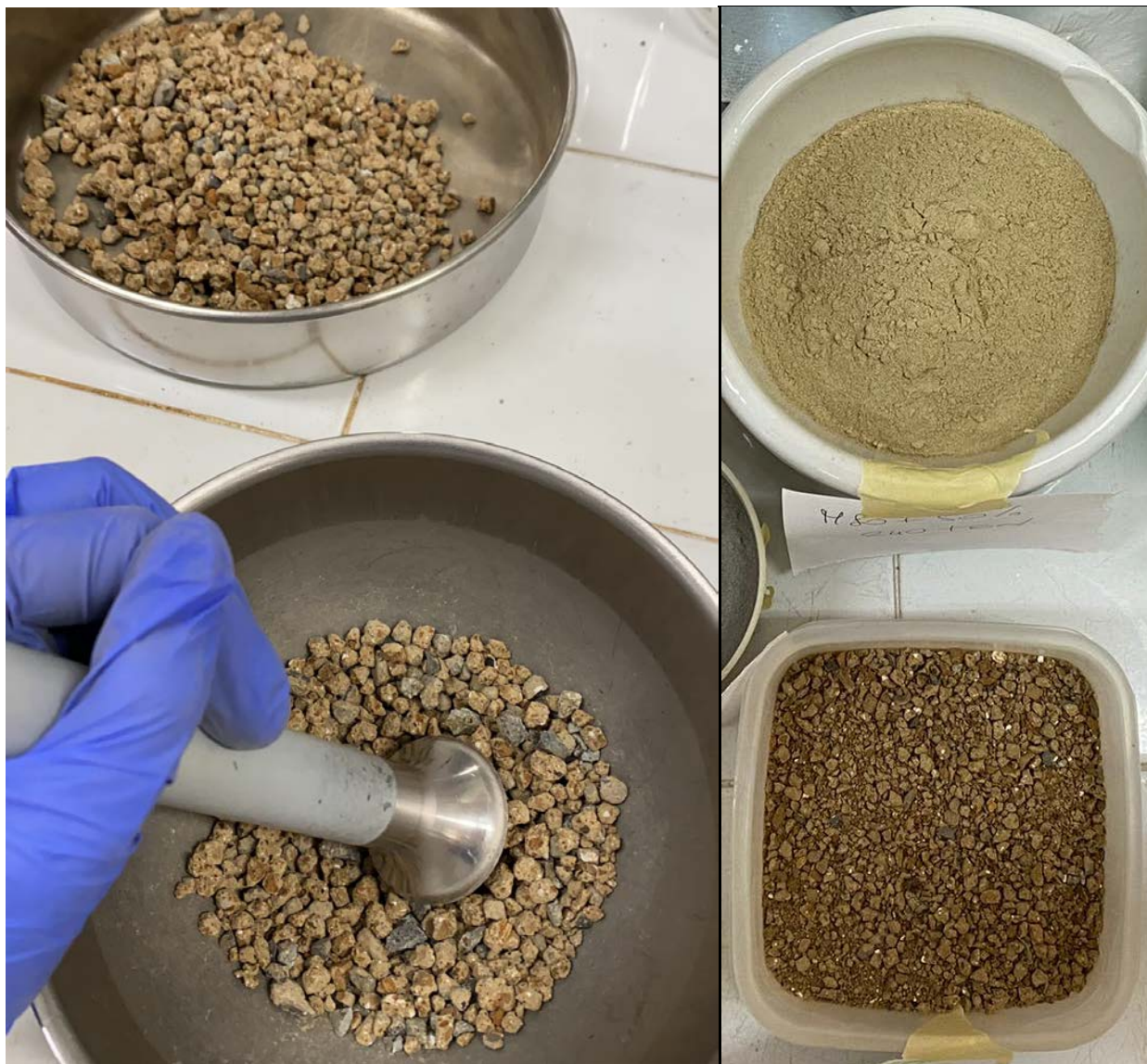
Figure n.15 - Crushing and collection of sieved material
