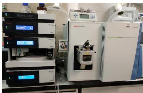
Figura 8. Cromatografia liquida-spettrometria di massa
