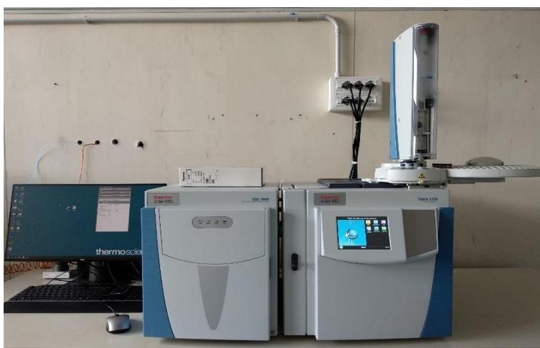
*Figura 7. Gascromatografia con spettometria di massa.*
