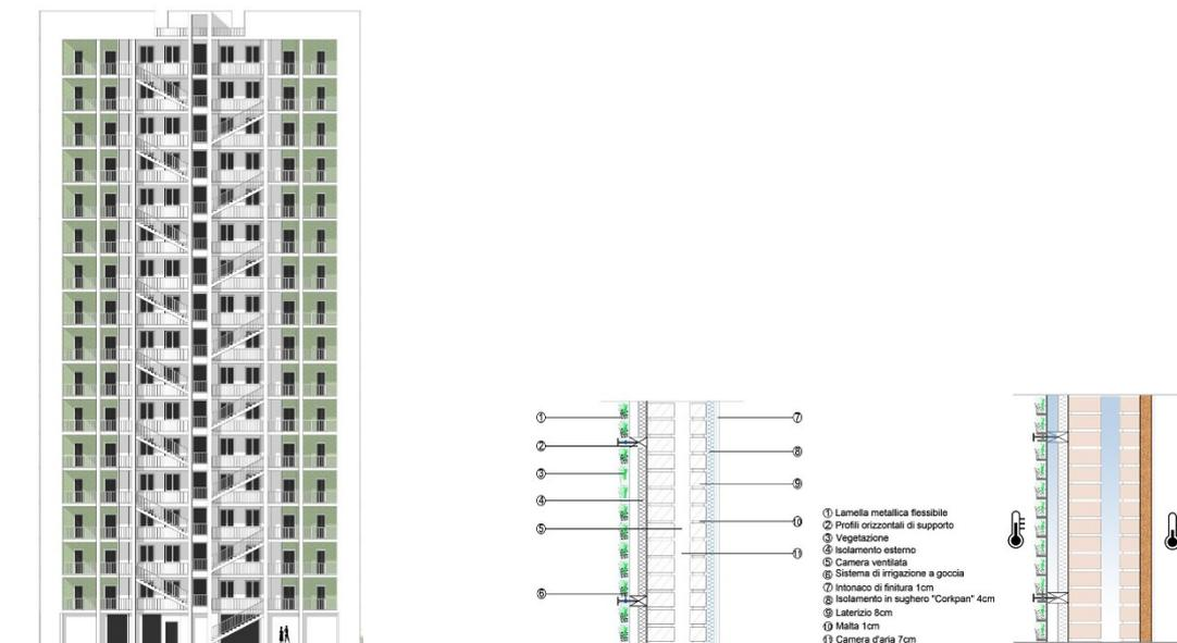
Figura 107 | Trattamento dell'involucro edilizio e dettaglio della soluzione tecnica. Prospetto sud-est
