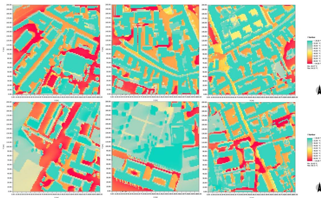
Figura 102| Simulazione ENVI-met della temperatura al suolo, Parco De Simone Comparto 9 P.S.E.R., Ponticelli, Napoli
