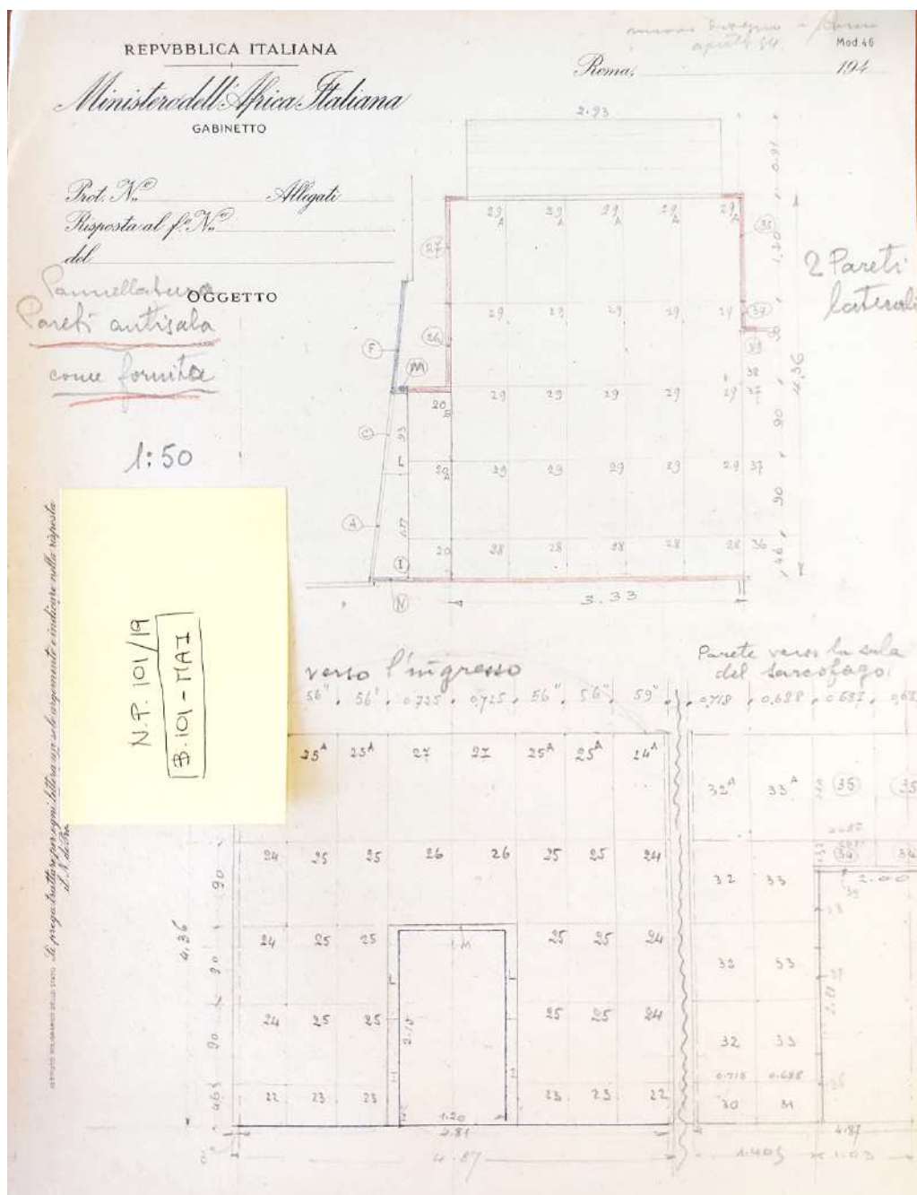
Figura 5- Disegni esecutivi relativi al Monumento al Legionario, Archivio Centrale dello Stato, Fondo del Ministero dell'Africa Italiana, busta 101. Esecutivo della posa delle lastre in marmo.
