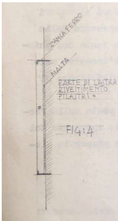
Figura 127- Lo schema mostra il sistema grazie al quale erano state ricollocate alcune lastre distaccatesi prima del 1937. L'operazione, condotta dalla ditta incaricata della manutenzione dell'edificio, prevedette un ancoraggio tramite zanche di ferro poste superiormente e inferiormente la lastra, previa apposizione di uno strato di malta. Fonte: Rapporto del 1937, Archivio Storico di Ferrovie dello Stato, Ministero delle Comunicazioni, Servizio lavori e costruzioni, serie C (Strada e Fabbricati) Cartella IIb 9 (I) XXVI, Edifici postali e telegrafici, busta 4860: Roma, quartiere Aventino – via Marmorata – costruzione di un fabbricato ad uso dei servizi postali e telefonici in Roma (Architetto Adalberto Libera), documento.000035.
