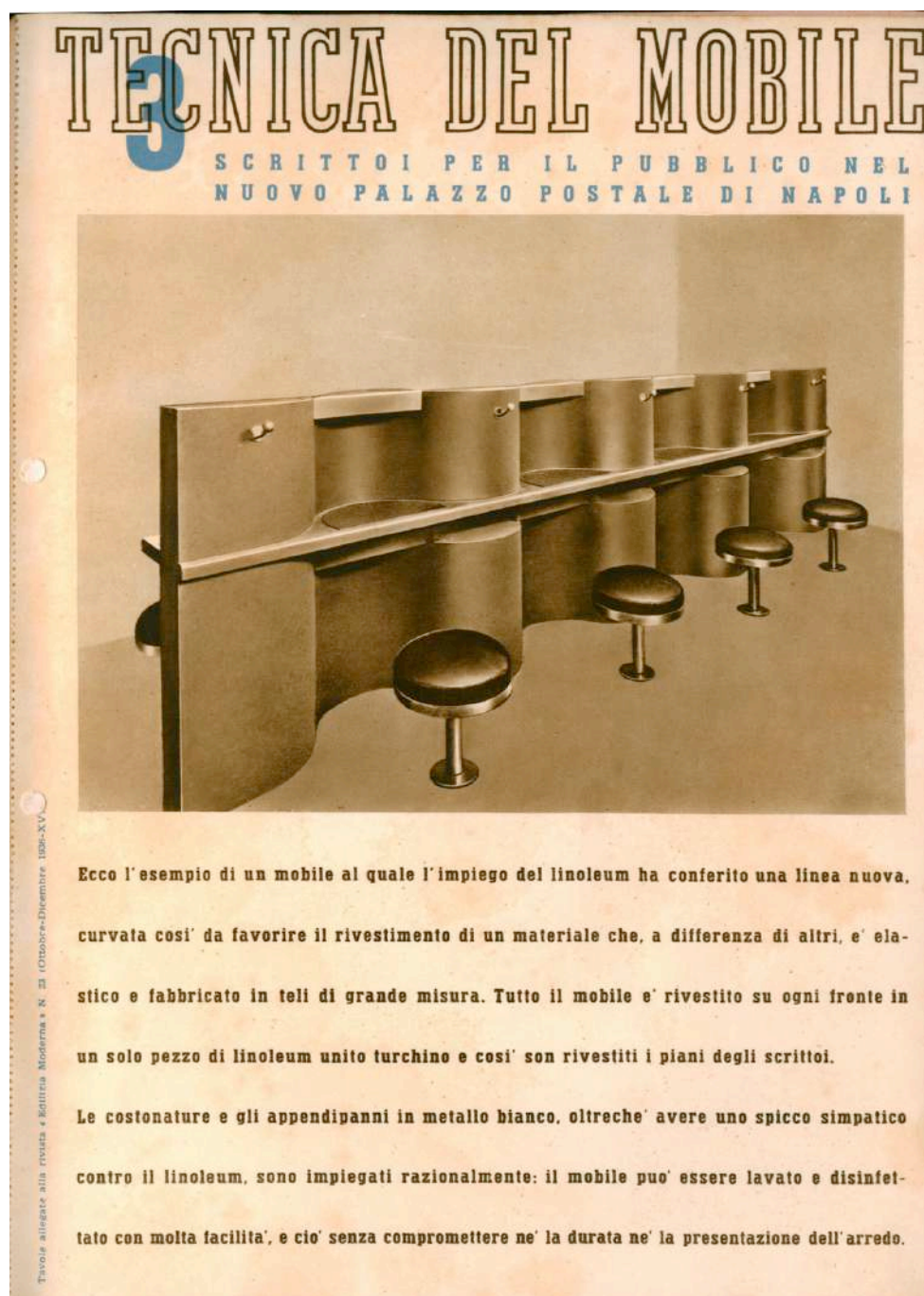
Figura 44- Progetto degli scrittoi per il pubblico nel Nuovo Palazzo Postale di Napoli, in cui viene esaltato il ruolo del linoleum e del metallo bianco, prodotti autarchici molto impiegati negli oggetti di arredo. Fonte: Fascicolo speciale di “Tecnica del mobile” n°3, pubblicato su Edilizia Moderna 23, ottobre-dicembre 1936.
