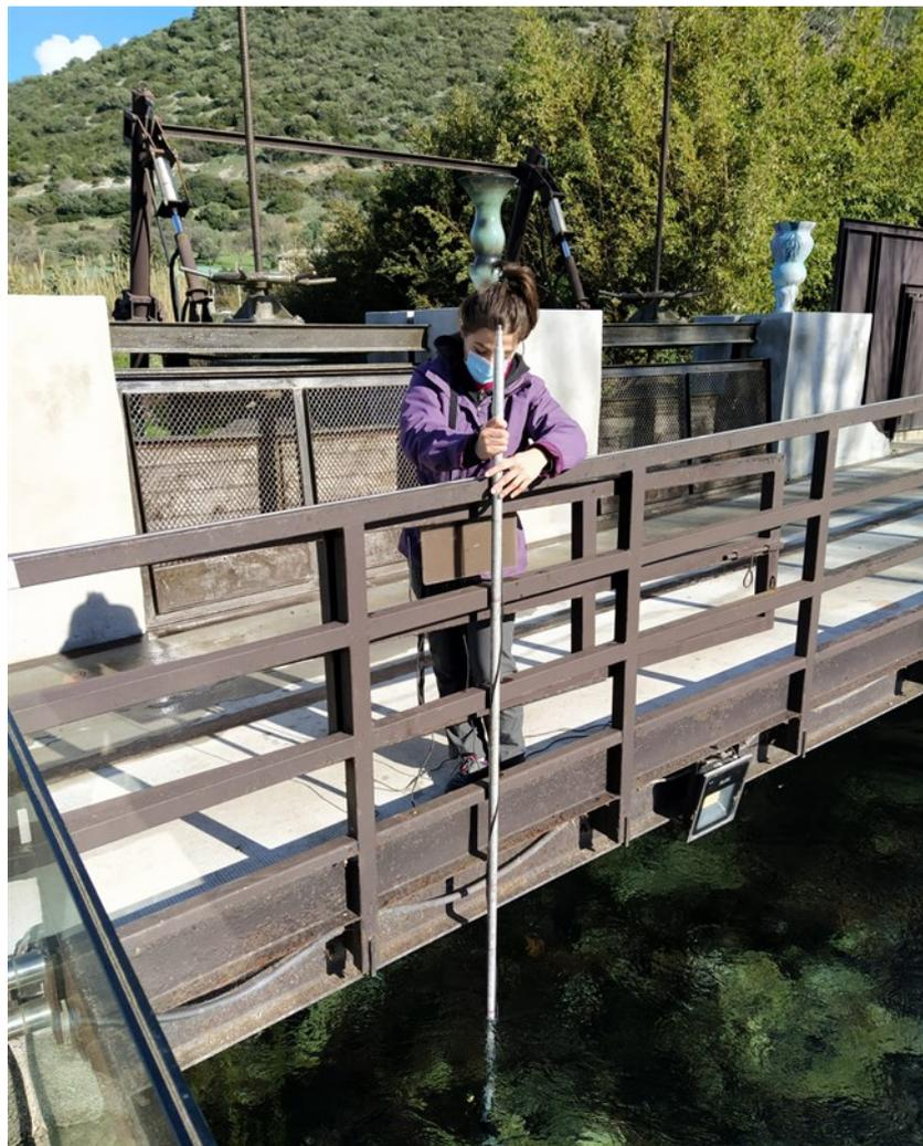
**Figura 28.** Misura di portata della sorgente Capodifiume.
