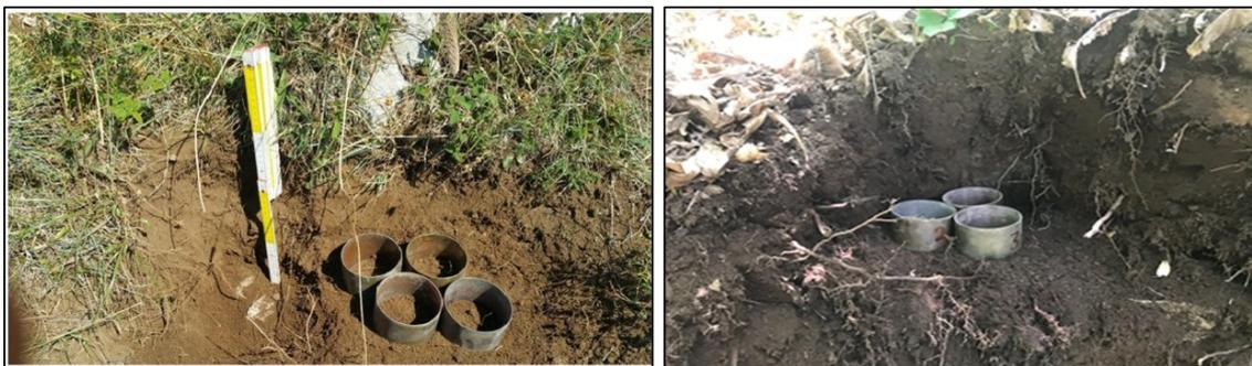
**Figura 30.** Anelli di ottone utilizzati per il campionamento di suolo indisturbato per le prove di caratterizzazione idraulica non satura di laboratorio.
