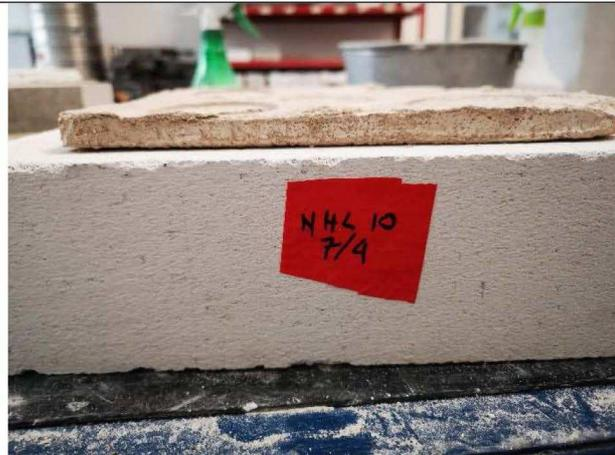
Figura 119. Preparazione dei campioni su Calcestruzzo Aerato Autoclavato della miscela NHL10 per la prova di aderenza al supporto, da sinistra: fessure da ritiro, distacco. Fonte: immagine di proprietà dell'autore del testo.
