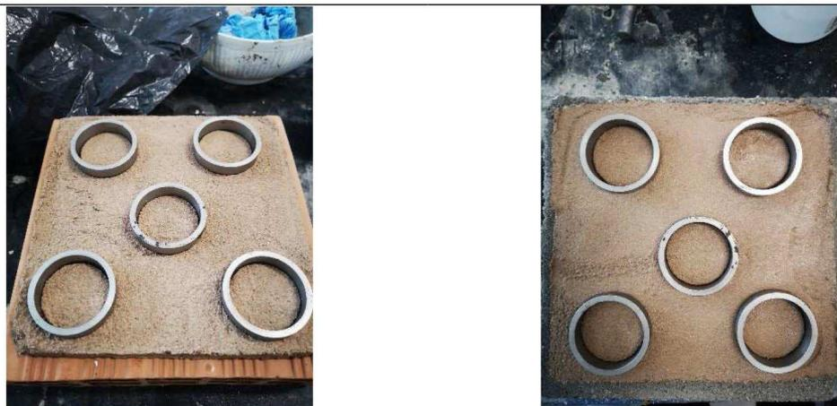
Figura 99. Prova di aderenza al supporto: preparazione campioni su laterizio e su calcestruzzo. Fonte: immagine di proprietà dell'autore del testo.
