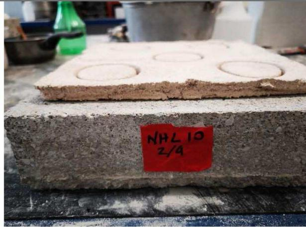
Figura 118. Preparazione dei campioni su calcestruzzo della miscela NHL10 per la prova di aderenza al supporto, da sinistra: vista dall'alto, distacco. Fonte: immagine di proprietà dell'autore del testo.
