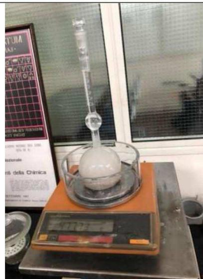
Figura 66. Fasi di misurazione delle proprietà fisiche dell'aggregato riciclato. A sinistra, aggregato immerso nel picnometro, a destra, picnometro con acqua fino al traboccamento. Fonte: immagine di proprietà dell'autore del testo.
