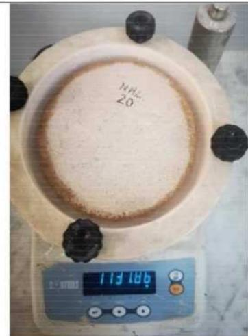
Figura 104. Prova di permeabilità al vapore acqueo: da sinistra, inserimento della soluzione nella camera inferiore, chiusura del sistema, pesatura del sistema. Fonte: immagine di proprietà dell'autore del testo.
