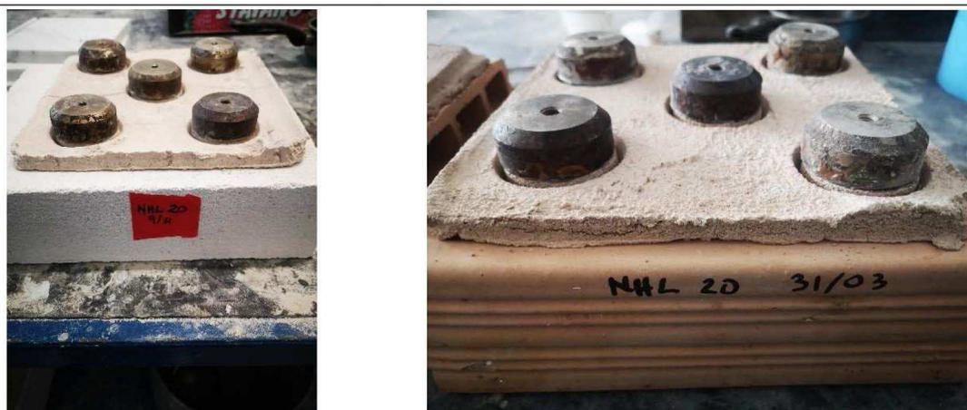
Figura 100. Prova di aderenza al supporto: incollaggio delle piastrine metalliche. Da sinistra: supporto in AAC, supporto in laterizio. Fonte: immagine di proprietà dell'autore del testo.
