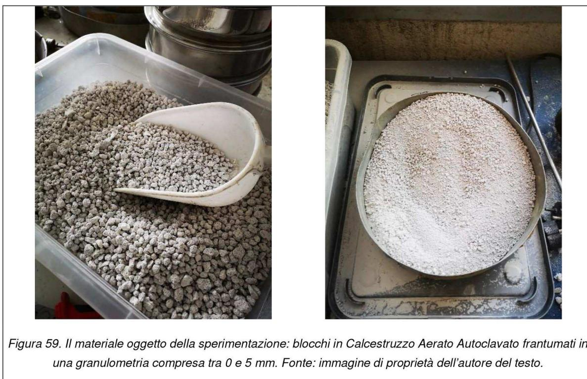
Figura 59. Il materiale oggetto della sperimentazione: blocchi in Calcestruzzo Aerato Autoclavato frantumati in una granulometria compresa tra 0 e 5 mm. Fonte: immagine di proprietà dell'autore del testo.
