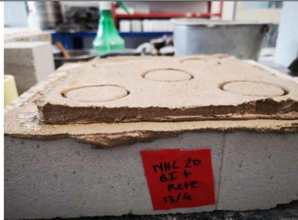
Figura 121. Preparazione dei campioni su Calcestruzzo Aerato Autoclavato con rete porta-intonaco della miscela NHL20 per la prova di aderenza al supporto, da sinistra: fessure da ritiro, distacco. Fonte: immagine di proprietà dell'autore del testo.
