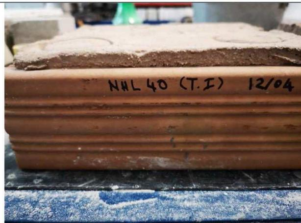
Figura 125. Preparazione dei campioni su laterizio della miscela NHL40 per la prova di aderenza al supporto, da sinistra: vista dall'alto, vista laterale. Fonte: immagine di proprietà dell'autore del testo.
