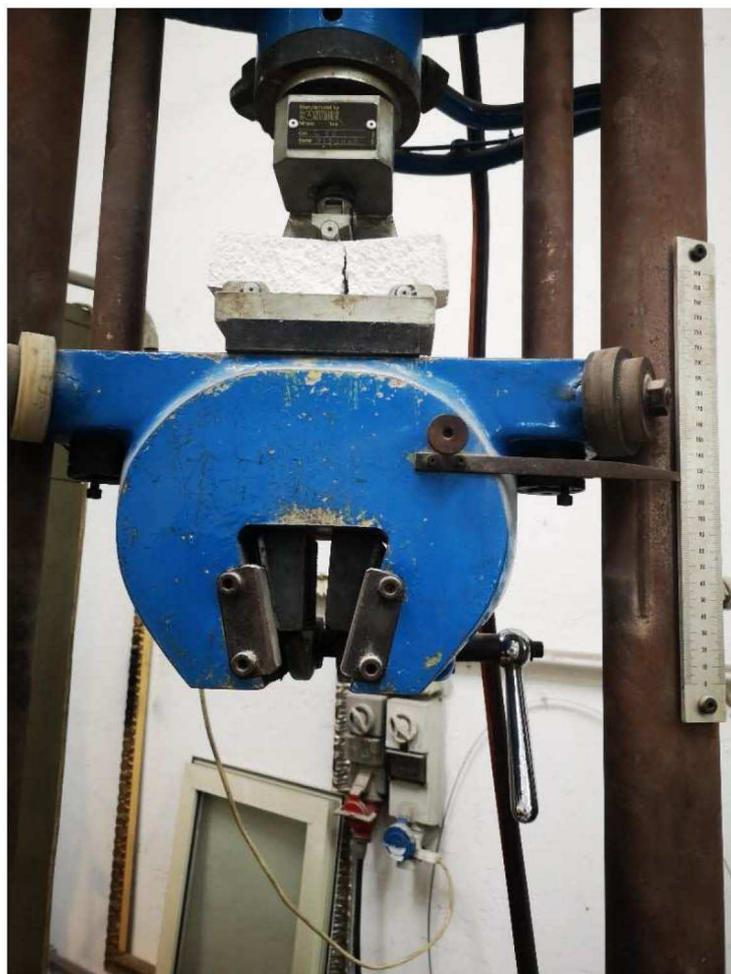
Figura 81. Attrezzatura per l'esecuzione della prova di resistenza a flessione a tre punti. Fonte: immagine di proprietà dell'autore del testo.
