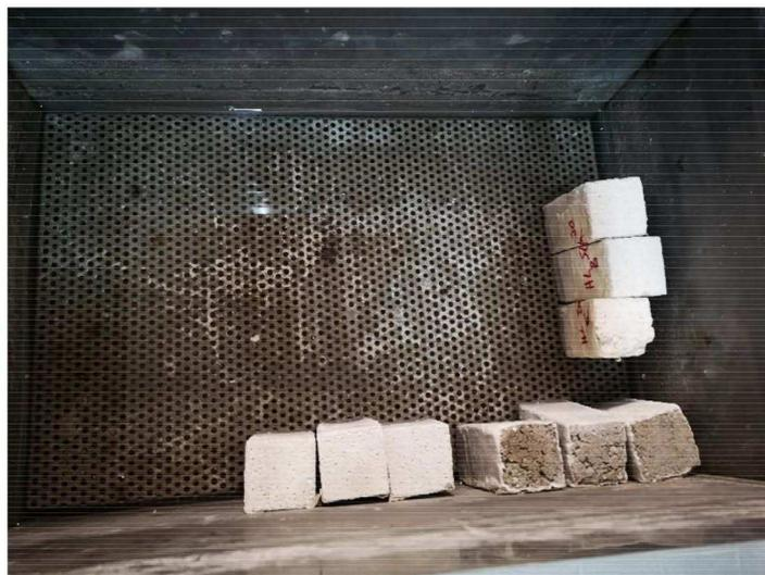
Figura 83. Esecuzione della prova di assorbimento d'acqua per capillarità: immersione dei provini in acqua.
