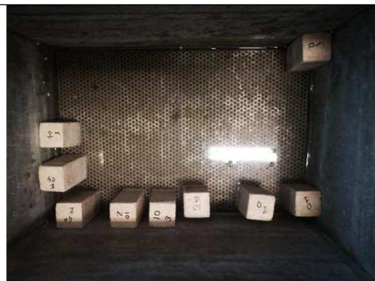
Figura 116. Prova di assorbimento di acqua per capillarità delle malte INT: inserimento dei provini nel volume d'acqua con le facce spezzate immerse. Fonte: immagine di proprietà dell'autore del testo.
