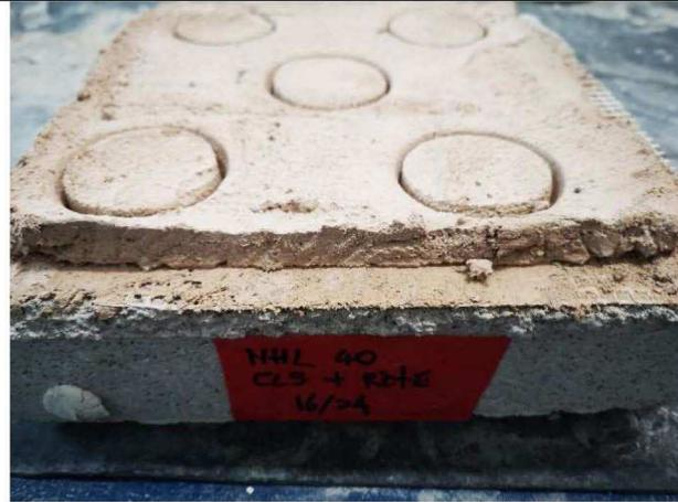
Figura 124. Preparazione dei campioni su calcestruzzo della miscela NHL40 per la prova di aderenza al supporto, da sinistra: fessure da ritiro, distacco. Fonte: immagine di proprietà dell'autore del testo.
