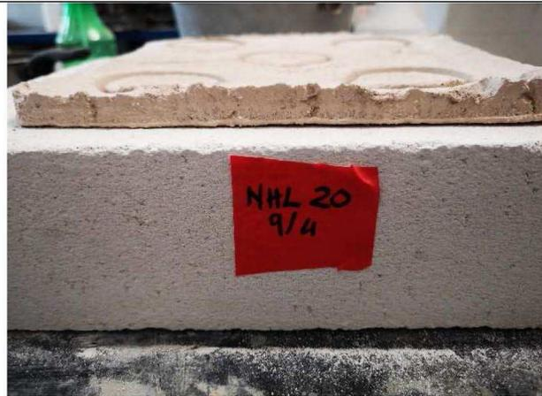
Figura 120. Preparazione dei campioni su Calcestruzzo Aerato Autoclavato della miscela NHL20 per la prova di aderenza al supporto, da sinistra: fessure da ritiro, distacco. Fonte: immagine di proprietà dell'autore del testo.
