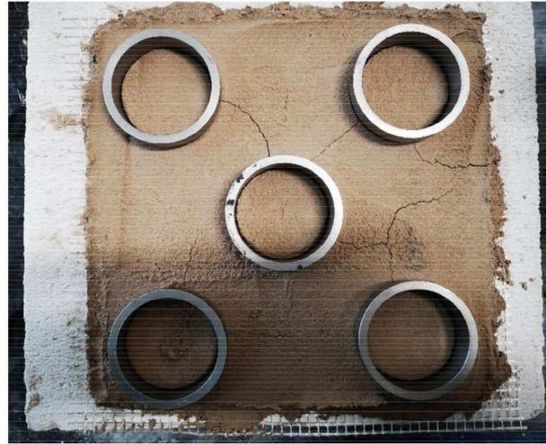
Figura 123. Preparazione dei campioni su Calcestruzzo Aerato Autoclavato della miscela NHL40 per la prova di aderenza al supporto: fessure da ritiro al momento della stesura della malta. Fonte: immagine di proprietà dell'autore del testo.
