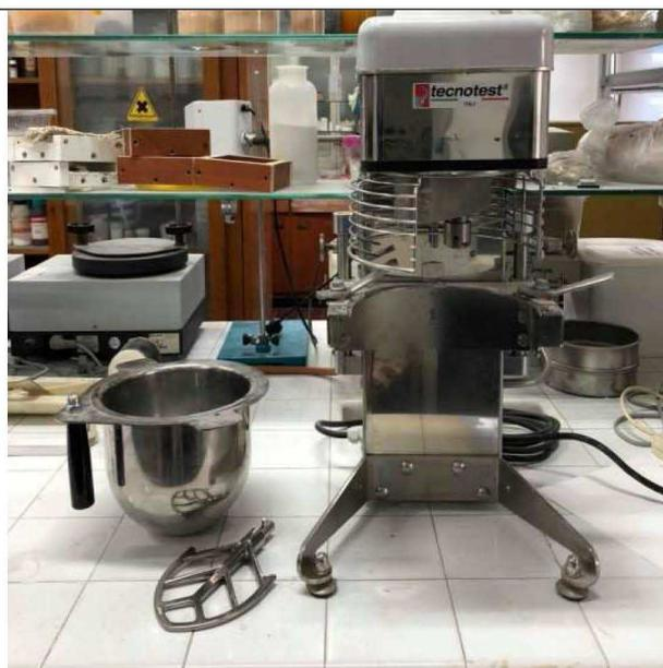
Figura 60. Mescolatrice planetaria impiegata per la preparazione dell'impasto. Fonte: immagine di proprietà dell'autore del testo.
