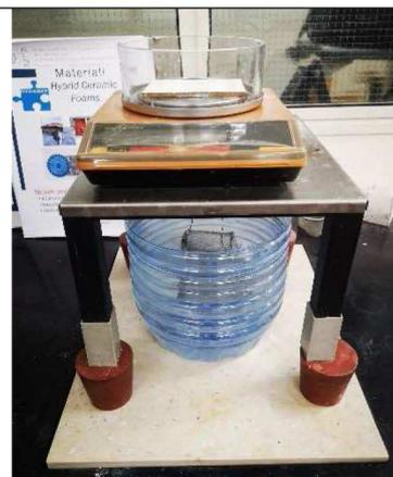
Figura 80. Misurazione di densità reale ed apparente, porosità e assorbimento d'acqua secondo la UNI 1936:2007: da sinistra, immersione sottovuoto dei provini e pesatura con bilancia idrostatica. Fonte: immagine di proprietà dell'autore del testo.
