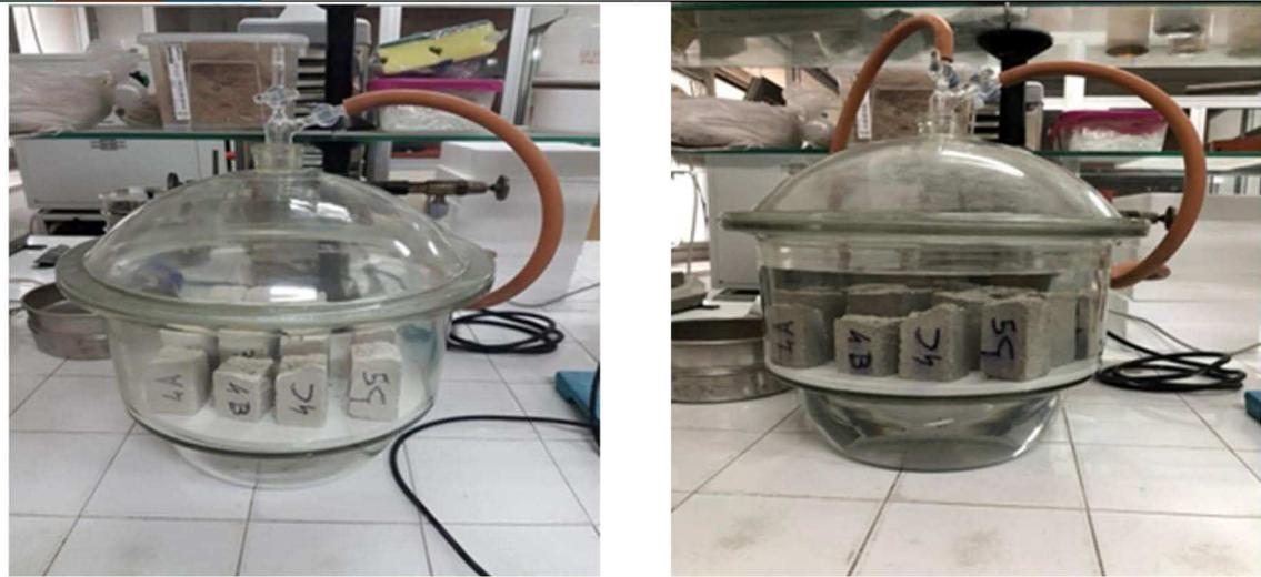
Figura 62. Condizionamento dei provini per la caratterizzazione fisica. A sinistra, inserimento nella camera e creazione del sottovuoto; a destra, inserimento dell'acqua per l'immersione dei provini. Fonte: immagine di proprietà dell'autore del testo.
