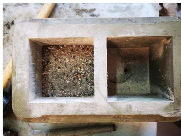
*Figura 77. Misura della massa volumica in mucchio degli aggregati secondo la UNI EN 1097-3:1999. A sinistra, pesatura dell'aggregato in Calcestruzzo Aerato Autoclavato; a destra, fase di riempimento del recipiente con la sabbia silicea. Fonte: immagine di proprietà dell'autore del testo.*
