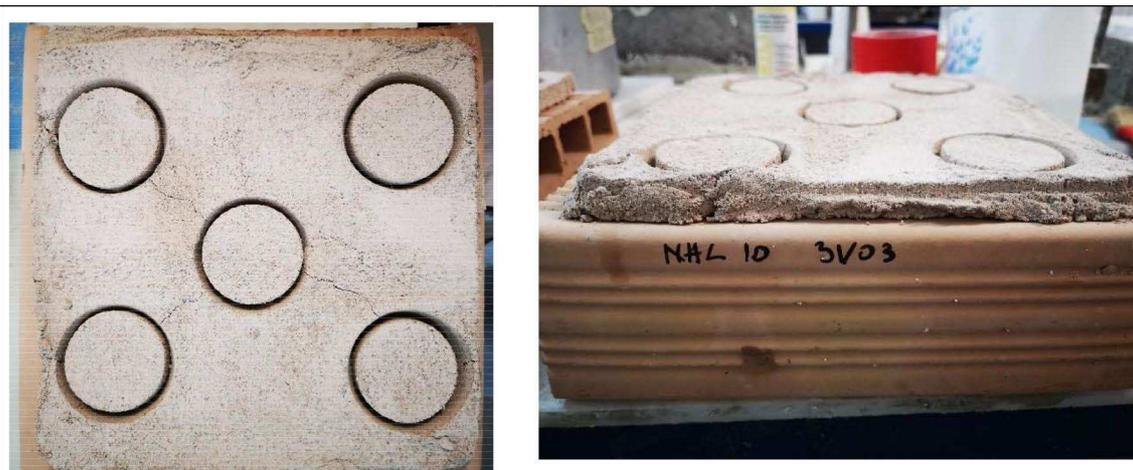
Figura 117. Preparazione dei campioni su laterizio della miscela NHL10 per la prova di aderenza al supporto, da sinistra: fessure da ritiro, distacco. Fonte: immagine di proprietà dell'autore del testo.
