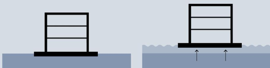
Meccanismo di funzionamento di un edificio flottante anfibio
