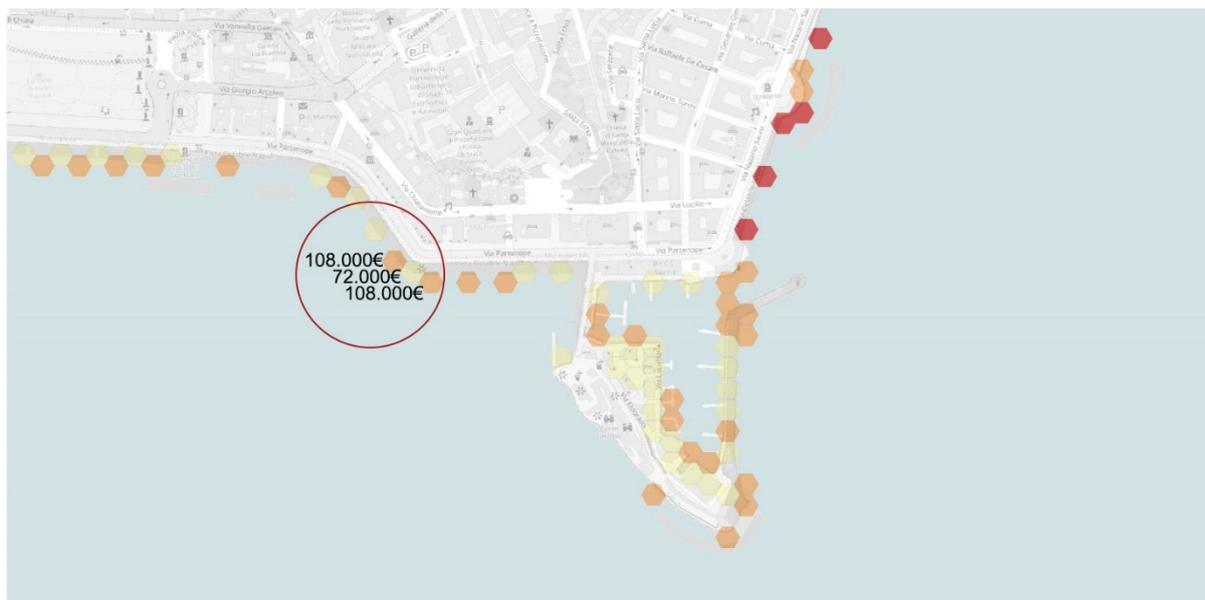
**Figura 46.** Applicazione sperimentale del modello Coast-RiskBySea nell'area interessata dalla mareggiata del 28.12.2020, simulazione per ESL 1,50m
