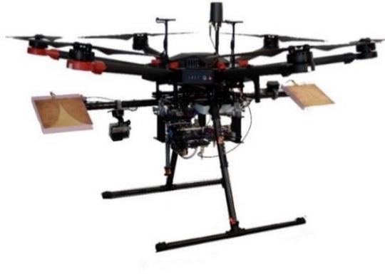
**Figure 3.** Picture of the UAV GPR system developed at the Deutsches Zentrum für Luft- und Raumfahrt (DLR), Germany.
