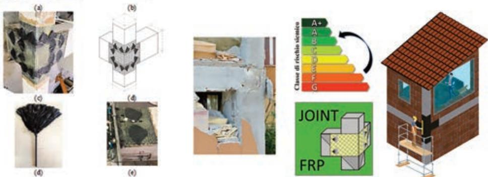
Fig. 2. Software di calcolo JOINT FRP ([www.reluis.it](http://www.reluis.it)).
