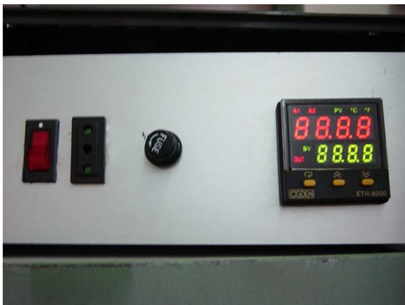
Figura 16-8 Lettore di termocoppia
