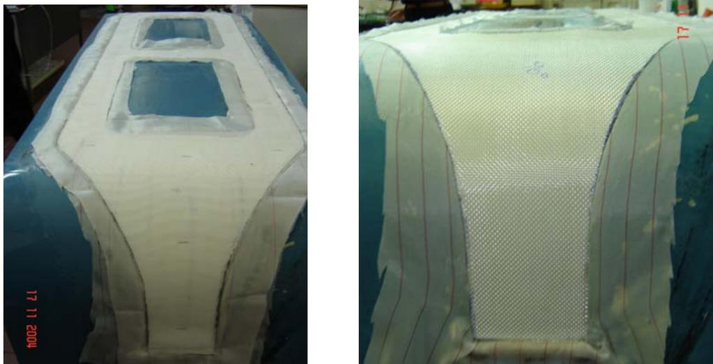
**fig. 14-5** Seconda pelle di fibre asciutte
