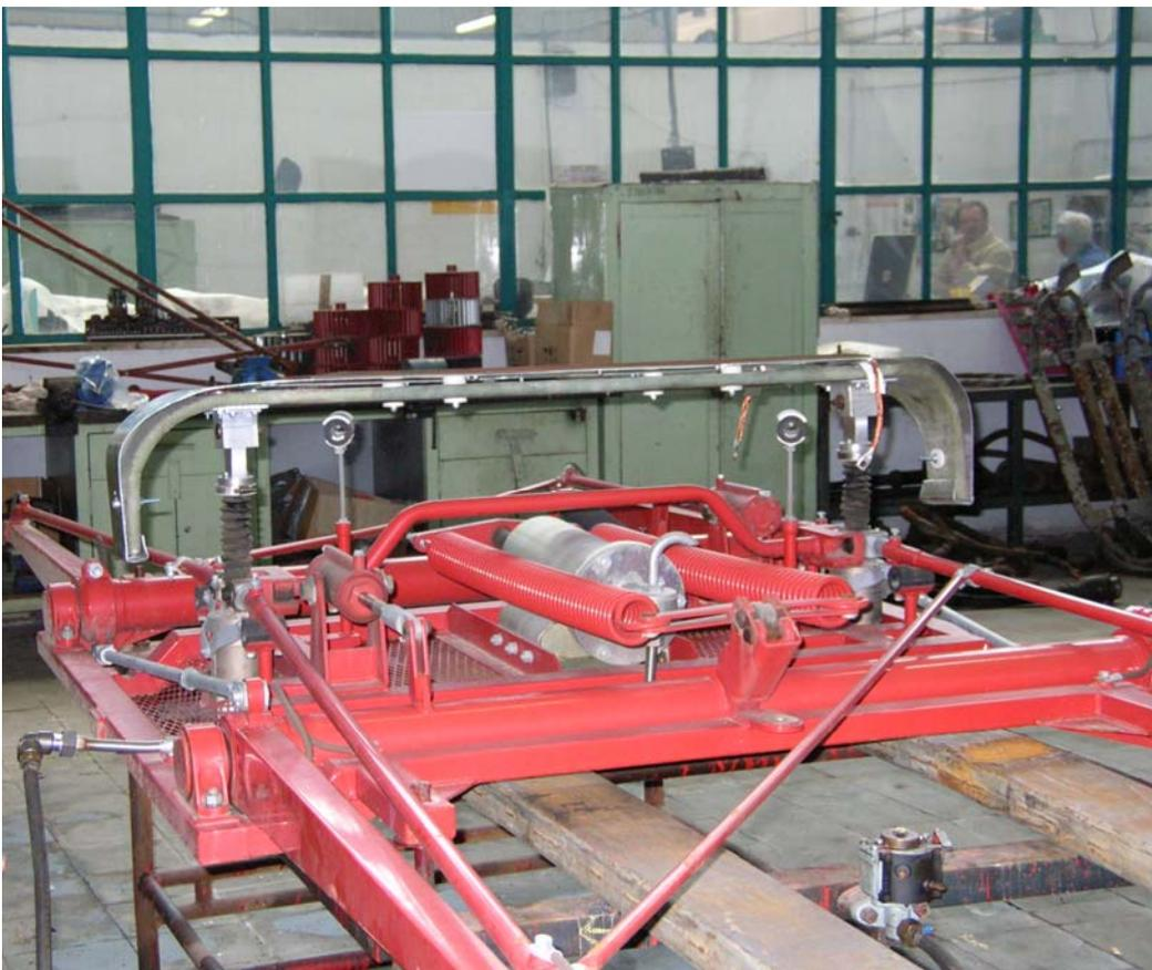
Il pantografo è stato smontato dal treno e da questo è stato smontato l'archetto originale, per montare l'archetto da noi realizzato sul pantografo è stato necessario variare leggermente l'interasse tra le due tasche che anche se di pochi millimetri era maggiore di quello dei braccetti delle sospensioni sulle quali viene collocato.
