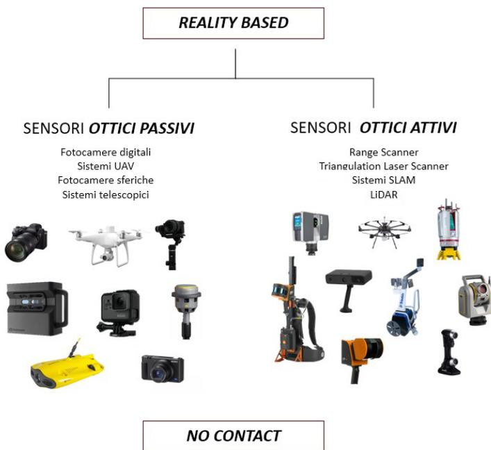
Fig. 12 \_ Classificazione strumentazioni image-based e range-based. Elaborazione S. Acquaviva
