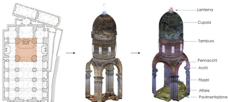
Fig. 29 \_ Segmentazione e classificazione dei modelli reality-based della Chiesa di Santa Maria degli Angeli a Pizzofalcone (Napoli). Fonte: S. Acquaviva et al., Reality-based model and 3d information systems: a gis 3d to mapping the crack panel of the church of Santa Maria degli Angeli in pizzofalcone in naples, 2022.
