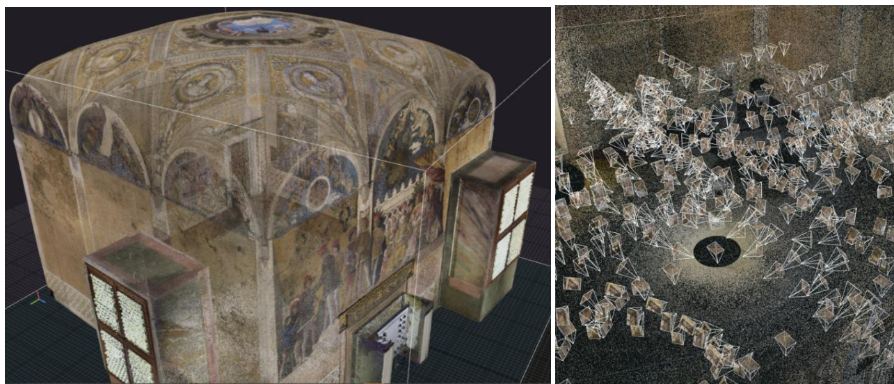
Fig. 9.1 Allineamento in un'unica nuvola di punti dei dati laser scanner e fotogrammetrici in Reality Capture .
