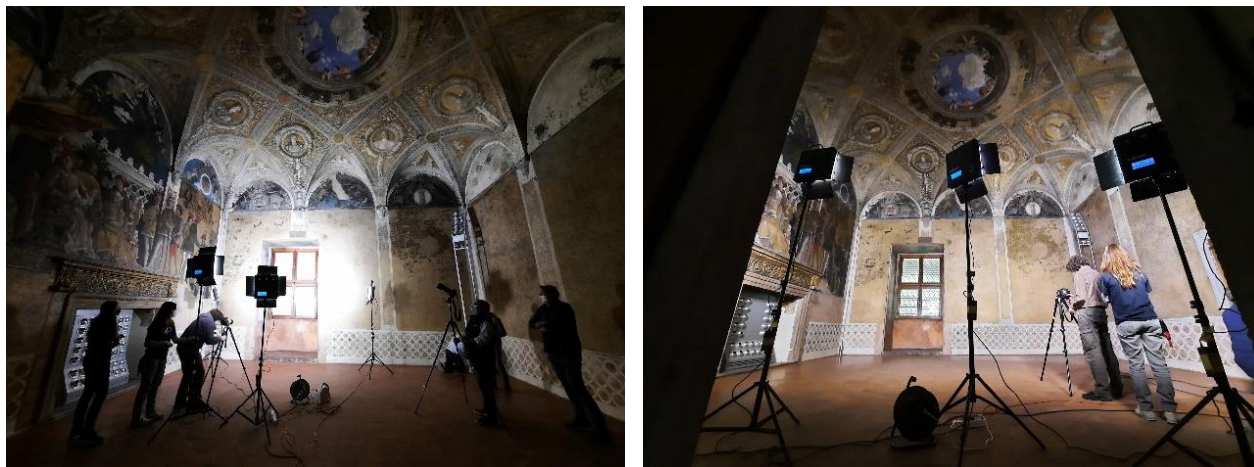
Fig. 7.13 Posizionamento di quattro lampade video Led per garantire una luce uniforme.
