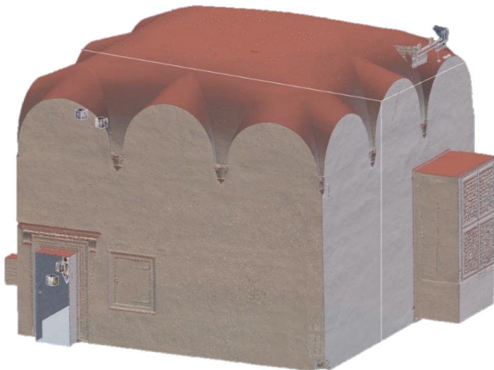
Fig. 9.2 Visualizzazione dall'esterno del modello mesh in Reality Capture .
