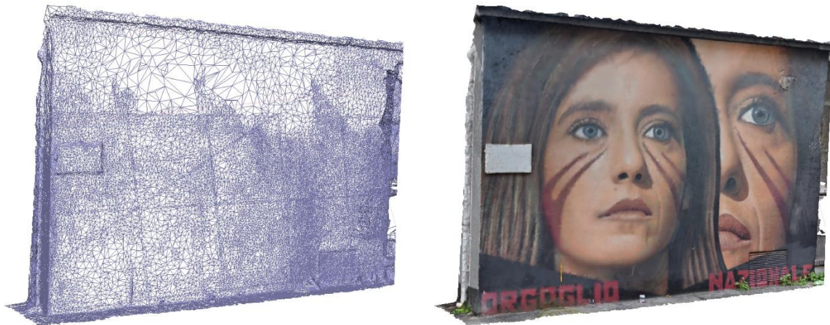
Fig 3.7 Rilievo di un murales di Jorit a Napoli. Visione wireframe della mesh e visione con texture applicata al modello.
