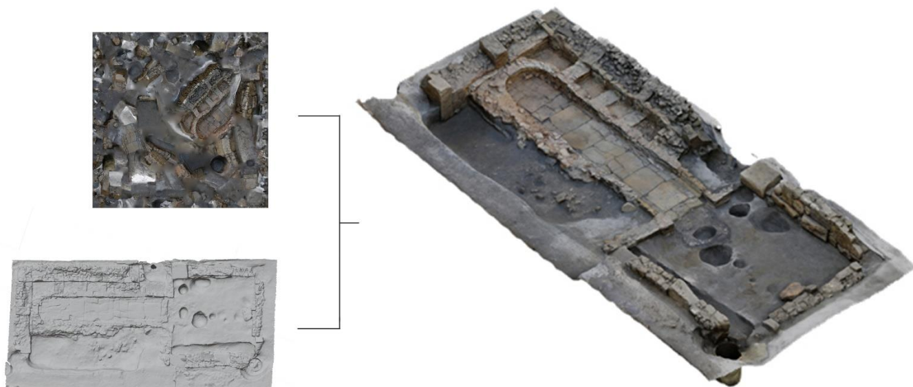
Fig. 3.12 Applicazione della texture ad un modello semplificato.
