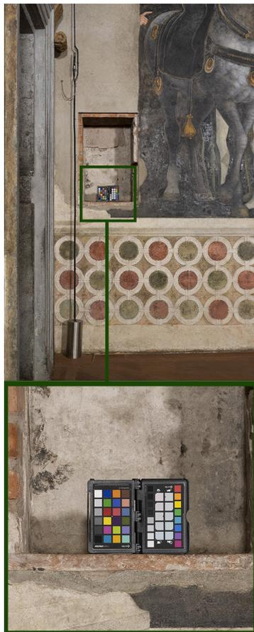
Fig. 3.13 - Color checker collocata sulla superficie da rilevare, utile per il bilanciamento dei colori delle foto .raw.
