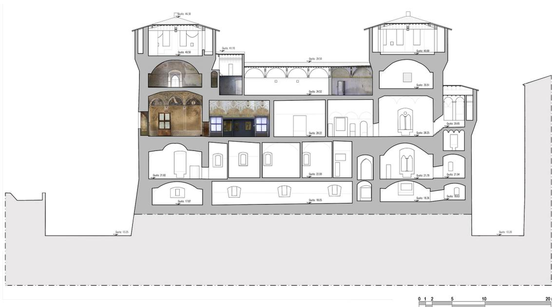
Fig. 3.9 - Sezione A-A' del Castel San Giorgio con informazioni RGB della nuvola di punti ove rilevata.
