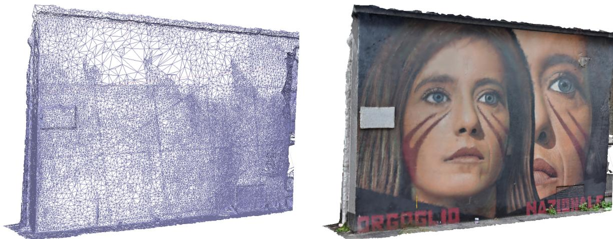
Fig. C.7 - Rilievo di un murales di Jorit a Napoli. Visione wireframe della *mesh* e visione con texture applicata al modello [Gallo, Scandurra, 2023]
