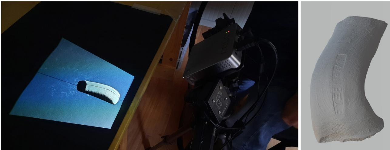
Fig C.5 - Rilievo laser 3D tramite SCAN in a BOX di un bollo e successiva mesh elaborata dall'autrice.
