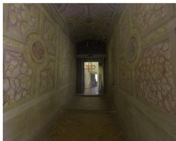
Fig. 3.2 - Nuvola di punti di due ambienti con condizioni di illuminazione differenti. Nel primo caso, l'ambiente non dispone di finestre, rendendo impossibile il controllo della luce naturale; il secondo è un ambiente cieco, privo di aperture. In questi contesti, il rilievo con laser scanner si dimostra particolarmente vantaggioso per la misurazione di spazi complessi, consentendo inoltre una registrazione agevole tra ambienti interni ed esterni.
