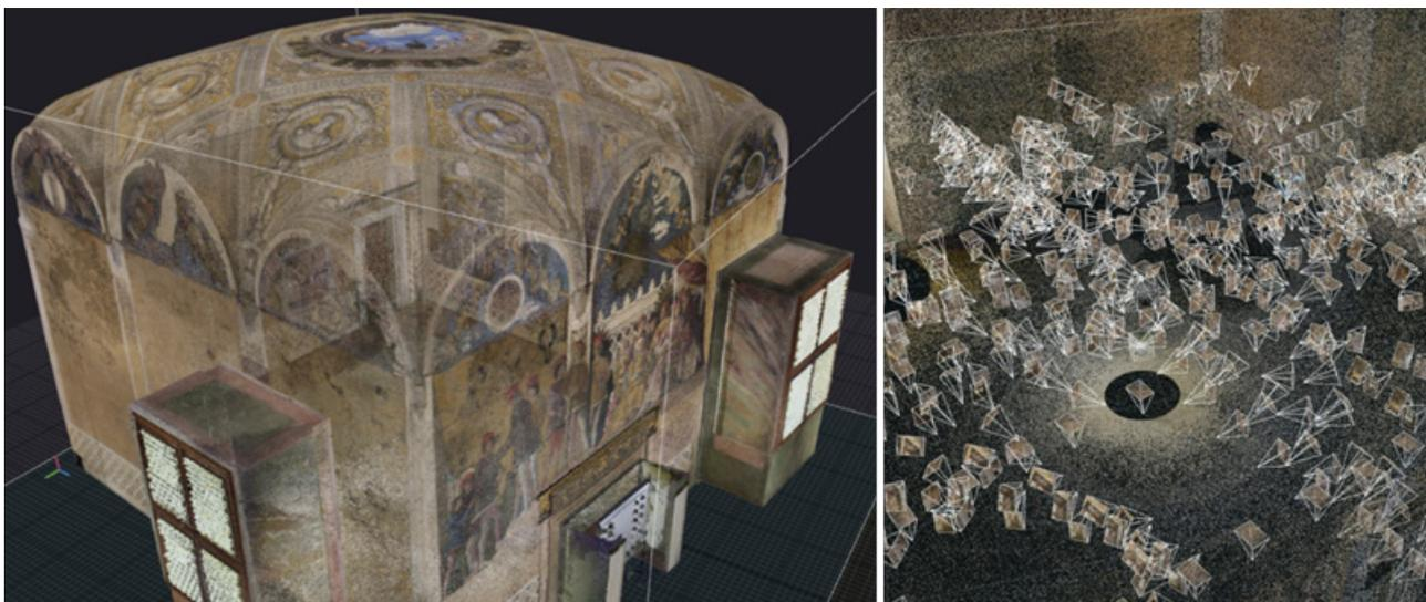
*Fig. 5.1 - Allineamento in un'unica nuvola di punti dei dati laser scanner e fotogrammetrici in RealityCapture. A sinistra: nuvola di punti completa vista dall'esterno; a destra: zoom su un punto interno della nuvola. Il cerchio nero corrisponde ad un punto di stazione, le piramidi corrispondono alle diverse prese fotografiche.*
