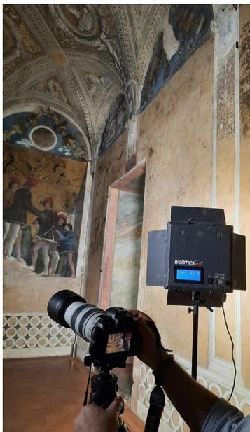
Fig. 3.11 - Macchina fotografica Canon EOS 5DS R durante il rilievo *image-based* della Camera degli Sposi.
