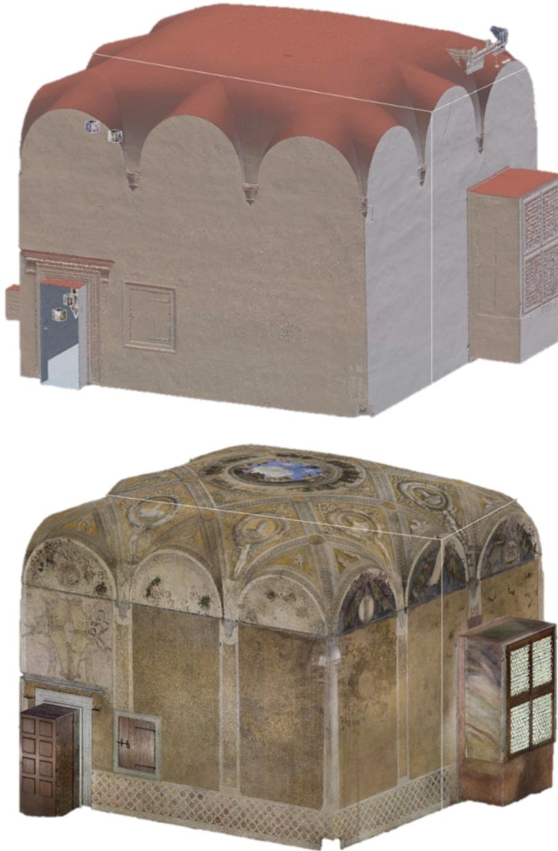
*Fig. 5.2 - Visualizzazione dall'esterno del modello mesh in RealityCapture. In alto: visualizzazione solida; in basso: visualizzazione texturizzata.*
