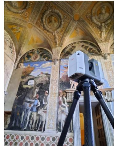
Fig. 3.1 - Laser scanner RTC360 durante il rilievo *range-based* della Camera degli Sposi.
