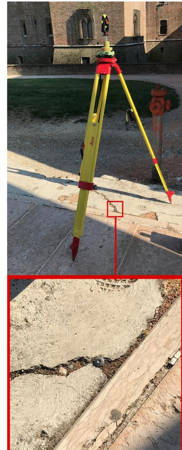
Fig. 2.4 Materializzazione del punto 1104 tramite vite topografica.
