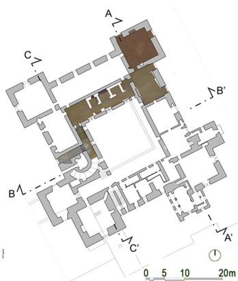
Fig. 3.8 - Pianta a quota 31 slm del Castel San Giorgio con informazioni RGB della nuvola di punti ove rilevata.
