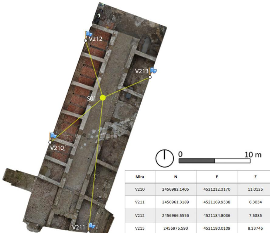
Fig. B.4. Inquadramento di una stazione totale 'S01' all'interno di una rete di inquadramento composta da capisaldi di coordinate geodetiche note nell'area delle scuderie del cantiere Archeologico Municipio di Napoli. [Gallo *et al.*, 2023]
