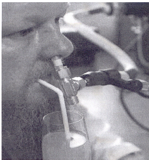
Fig. 1 Principio di applicazione del campionatore del nosespace.
