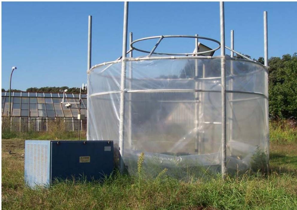
**Foto 2:** Open Top Chamber (OTC) con sistema di filtraggio dell'aria.
