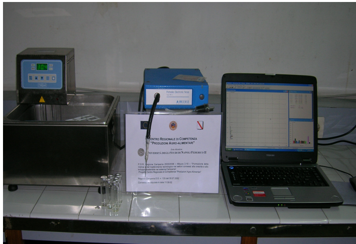
Figura 1.2.1: Strumentazione portatile (naso elettronico PEN 2) impiegata nella presente ricerca.
