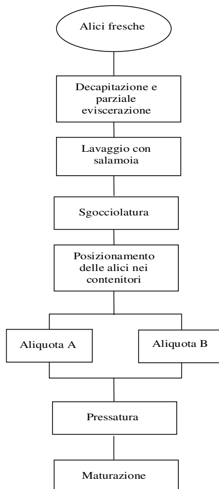
Figura 5.3.1.2. Diagramma di flusso della lavorazione dei campioni di alici utilizzati nel presente lavoro di tesi.
