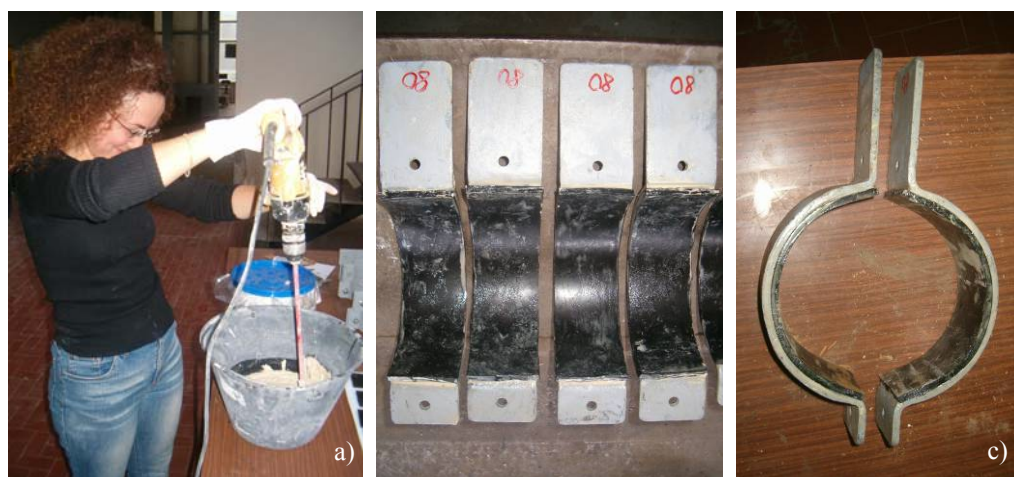
Fig. 5.5.41. Preparazione provino: a) Colla; b,c) Manicotto.
