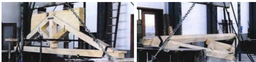
Fig. 1.2.7. Capriata ad "ad arco": collasso per sbandamento laterale.
