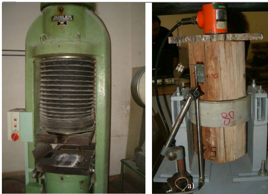
Fig. 5.5.40. a) Macchina di carico AMSLER; b) Posizione trasduttori e cella di carico.
