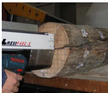
Fig. 2.1.3. Indagine resistografica: a) Prova; b) Grafico resistenza alla punta-penetrazione.
