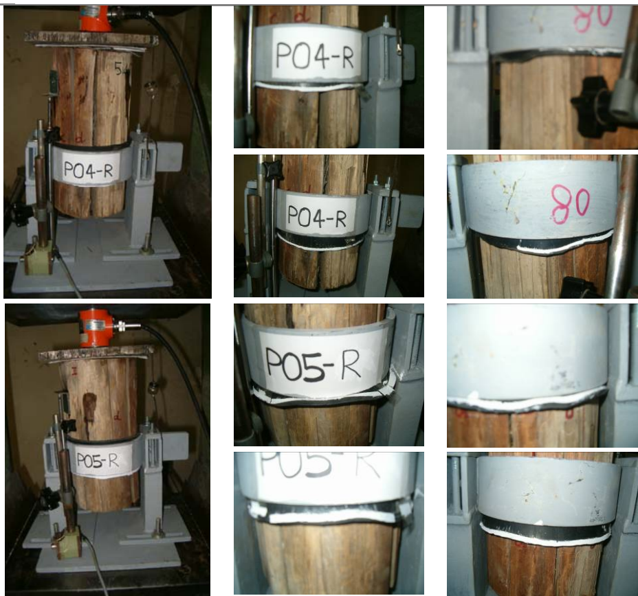
Fig. 5.5.45. Provini PO3-R, PO4-R e PO5-R in alcune fasi della prova. (continua)
