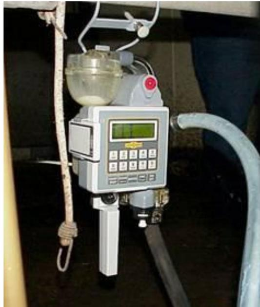
Il lattoflussometro rileva il flusso di latte in uscita dalla mammella, a intervalli di tempo regolari di 2.8 secondi (valore che rappresenta la media di 4 intervalli di misura consecutivi di 0,7 secondi) fornendo sia il grafico della curva di emissione del latte (Fig. 1), che una serie di parametri numerico descrittivi della stessa. Tra le variabili si ricorda:
