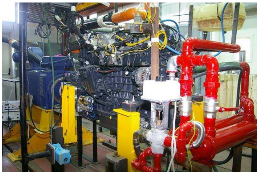
Figura 19. IVECO CURSOR 8 GNC al banco dinamico presso l'Istituto Motori del CNR
