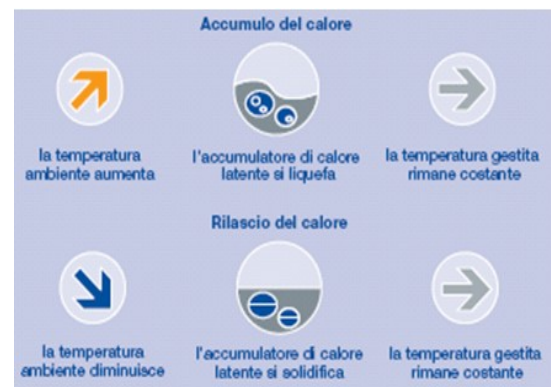
Figura 20: comportamento delle microcapsule, in caso di accumulo o rilascio di calore
