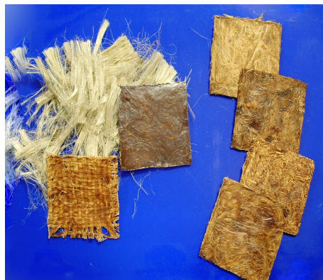
Figura 22: Provini quadrati delle dimensioni di 6,5 cm×6,5 cm×0,35 cm .
