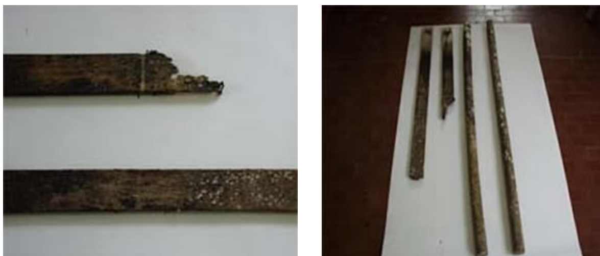
Figura 5: Pali compositi e campioni di legno prelevati dopo 1 anno di immersione in acqua
