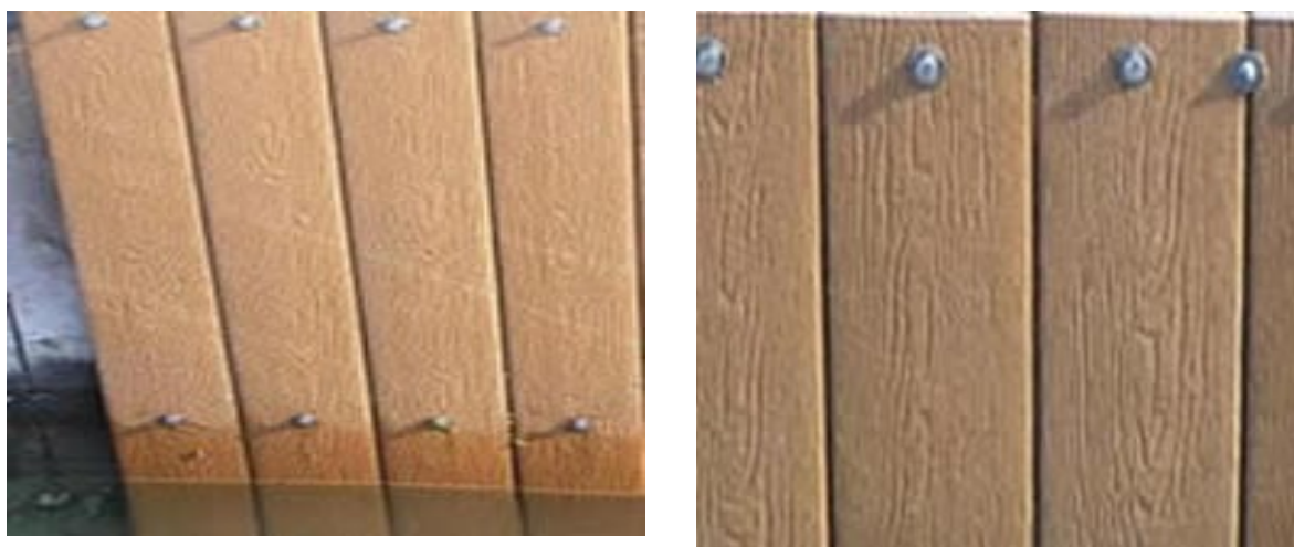
Figura 6: Il materiale presenta un'ottima finitura superficiale, lavorabile come il legno
