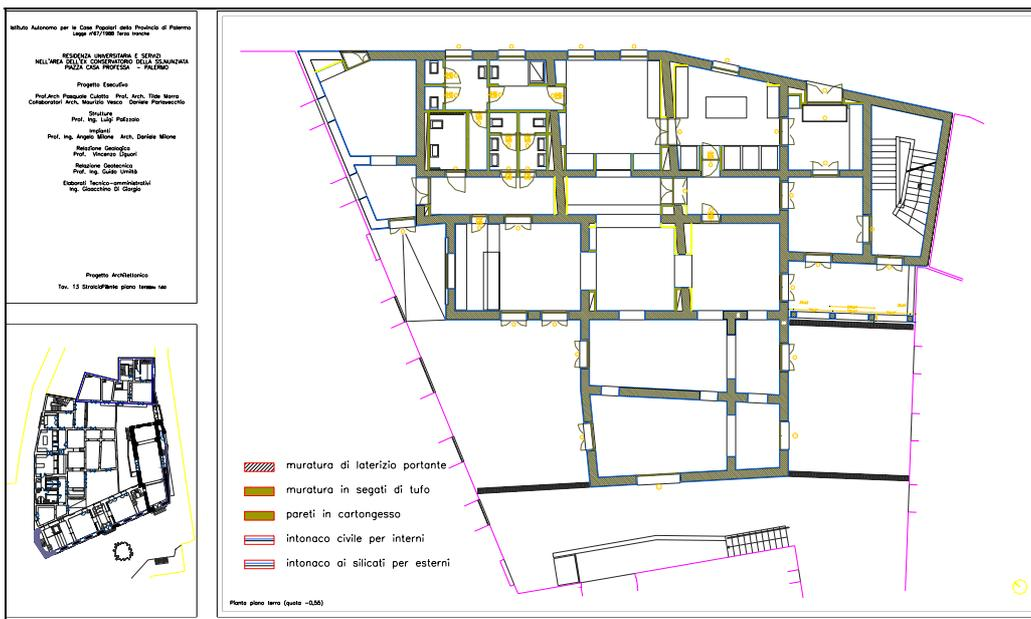
6.1.2 - Fig. 31: Pianta delle indicazioni tecnologico-costruttive
