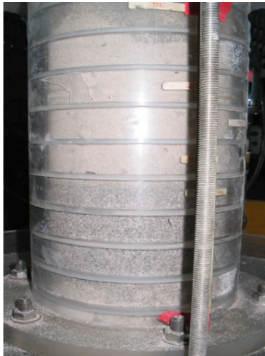
Figura 5.44: Foto scattata durante la prova di fluidizzazione eseguita sulla miscela di Avellino fall. Al fondo del letto si vede una fascia di materiale chiaro (pomici) ed al centro del letto una fascia di materiali scuri (frammenti di litici e cristalli).
