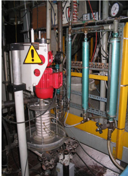
Figura 4.2: Foto dell'impianto formato dalle due colonne coassiali ed il dispositivo di agitazione.
