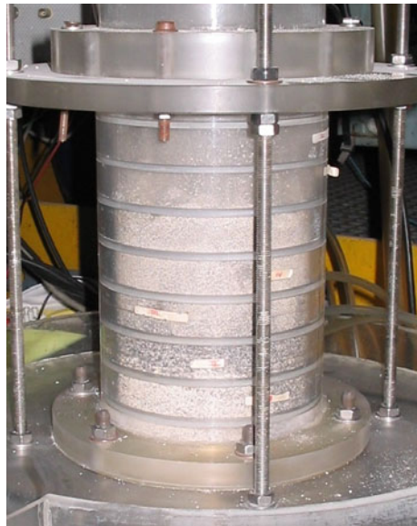
Figura 5.33: Foto scattata durante la prova di fluidizzazione eseguita sulla miscela di Avellino Fall. Al fondo del letto si vede una fascia di materiale chiaro (frammenti pomice) ed al centro del letto una fascia di materiali scuri (frammenti di litici e cristalli).
