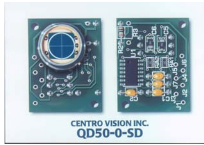
Figura 2.8 - Foto del fotodiodo a quadranti QD50-0-SD
