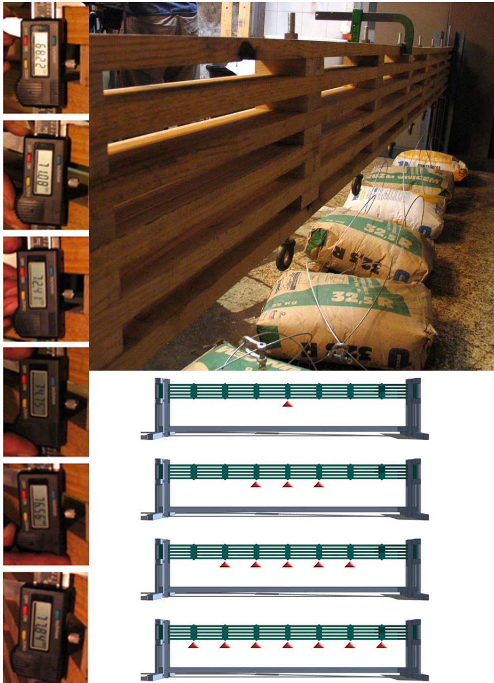
Fig. 12: Il travetto caricato, gli abbassamenti misurati con il calibro micrometrico e la successione delle fasi di carico della struttura.
