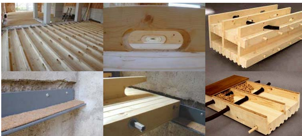
Fig. 15: Sistema brevettato LegnoLegno. Da sinistra una delle fasi intermedie nel montaggio del solaio; le sole per il passaggio degli impianti; il sistema a doppia orditura; per l'appoggio al muro si prevede la sistemazione di un profilo a L su cui è interposto un materassino di juta.
