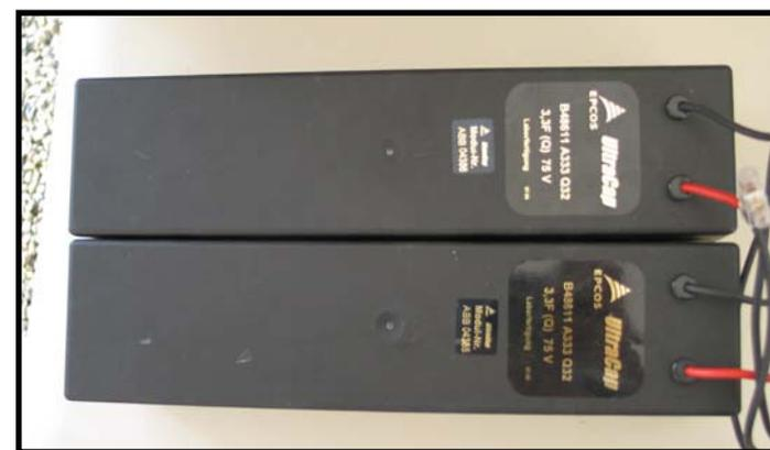
Fig.14 – Sistema di condensatori elettrochimici
