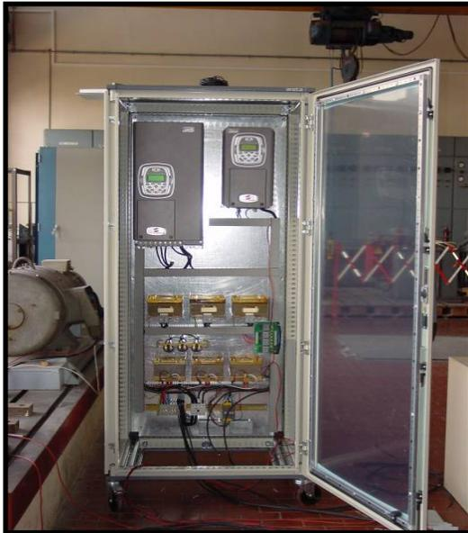
Fig.8 – Convertitore dc/dc bidirezionale
