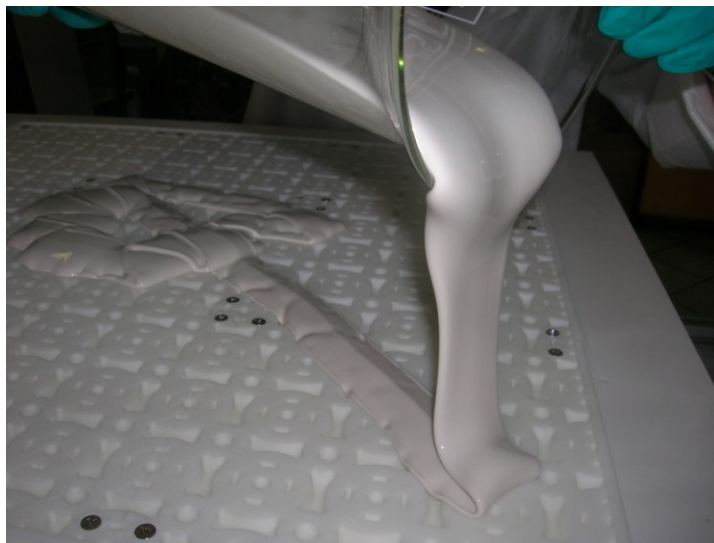
Figura 5-5 Preparazione della membrana
