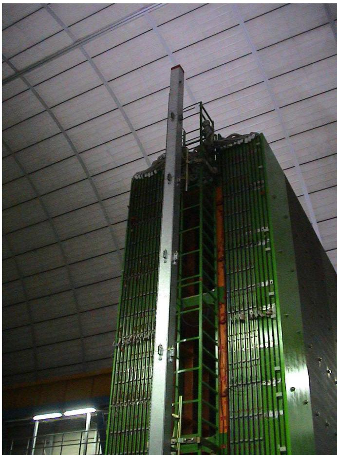
Figura 3.12: Scorcio laterale del primo spettrometro, Maggio 2004. Sono visibili le estremità delle bobine di pick up per il monitoraggio del campo magnetico.
