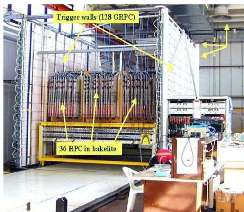
Figura 4.11: Apparato sperimentale per effettuare i test con i raggi cosmici. Sono indicate le tre casse contenenti 12 RPC ciascuna e le due pareti di RPC in vetro per il trigger.
