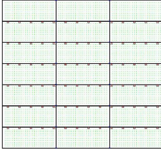
Figura 3.10: Piano di  $7 \times 3$  RPC. Le camere poste nella fila in alto sono di tipo A. Le altre, di tipo B, si differenziano per il profilo con spazi ricurvi per fare spazio ai perni filettati da 36 mm su cui vengono imbullonate le lastre di ferro.
