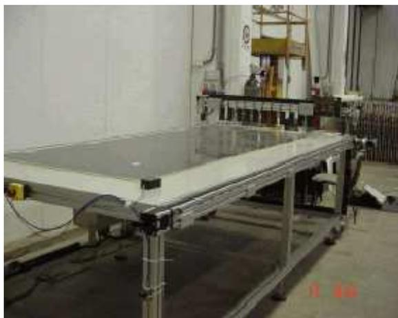
Figura 4.4: Banco per i test meccanici sul quale è disposto un RPC. In fondo sono visibili i pistoni per l'ispezione degli spaziatori.
