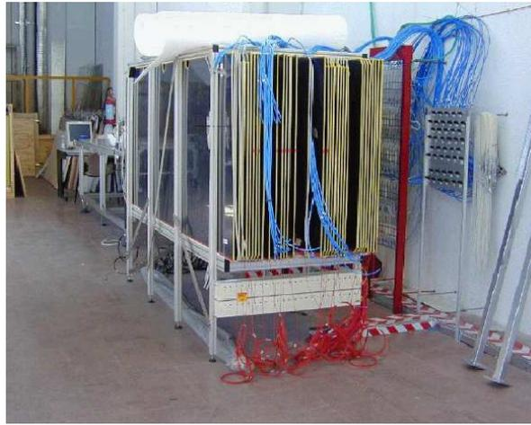
Figura 4.8: La racchettiera che ospita i 48 RPC per i test elettrici.
