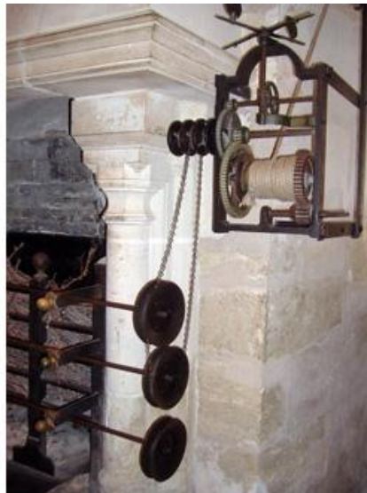
Fig.12: Ricostruzione del disegno di Leonardo per il girarrosto, Castello di Chenonceaux (Francia)
