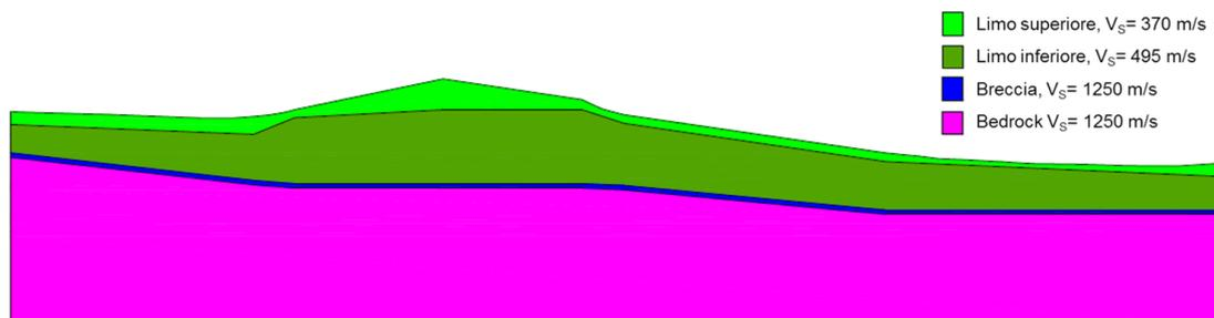
**Figura I.16.** Modello sottoposto ad analisi con codice di calcolo FEM (F. Rotili, 2010)
