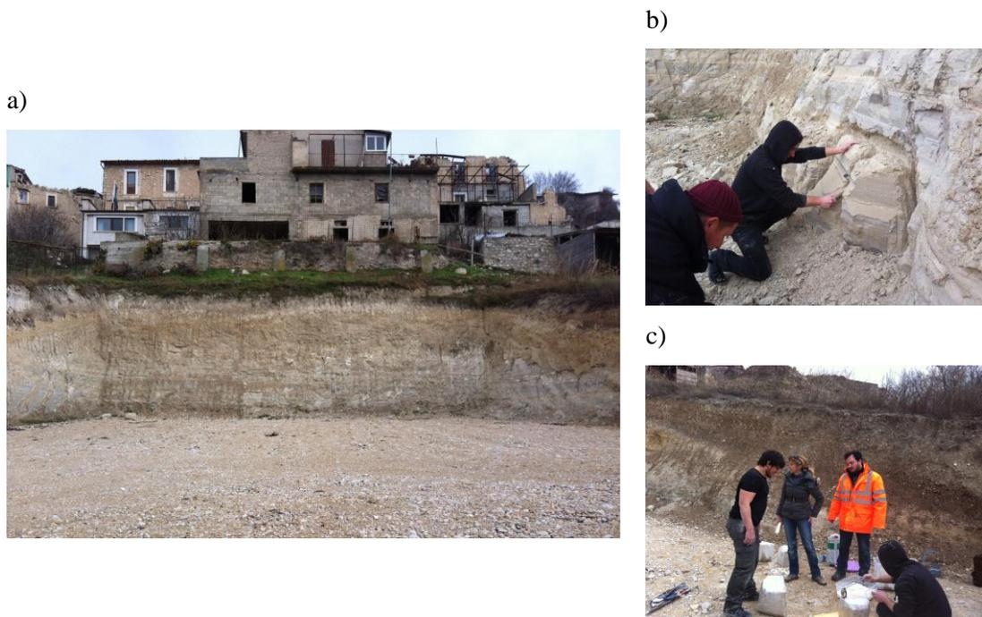
**Figura III.7** Fronte di scavo da cui sono stati prelevati icampioni indisturbati a), prelievo dei bocchi b) e sigillatura c).
