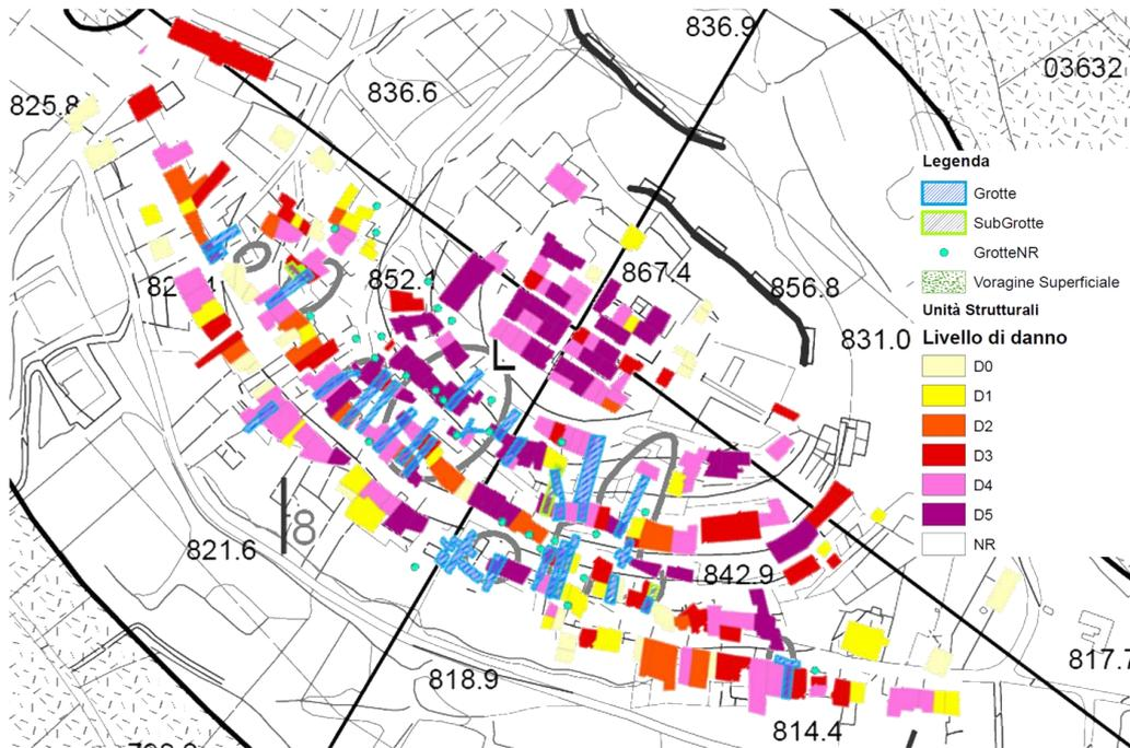
**Figura I.6.** Carta del danno rilevato (Borghini et al. 2011)
