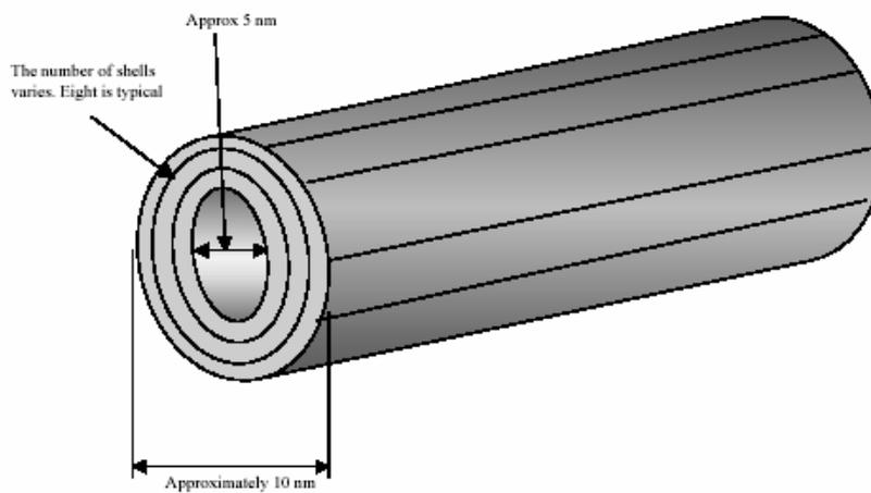
Figure(II)-4: Carbon nanotube
