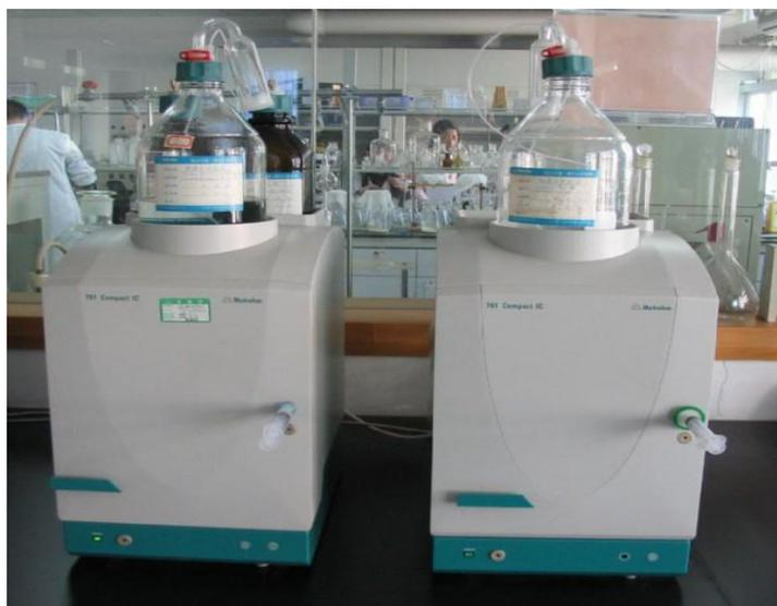
Figura 8 - Cromatografo ionico IC - Metrohm 761
