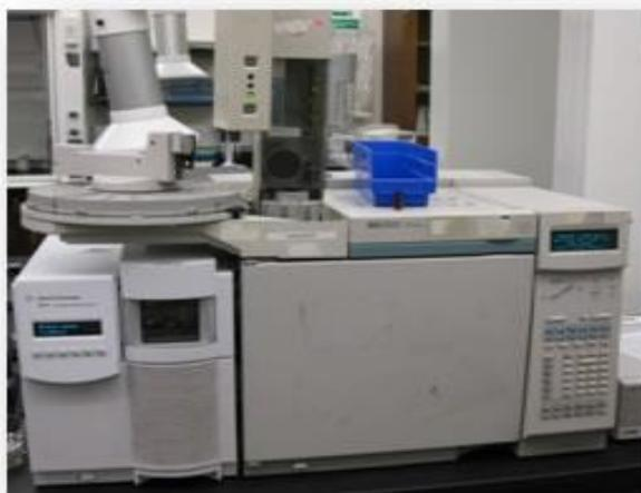
**Figura 11** - GC (Agilent 6890) MS (Agilent 5973)
