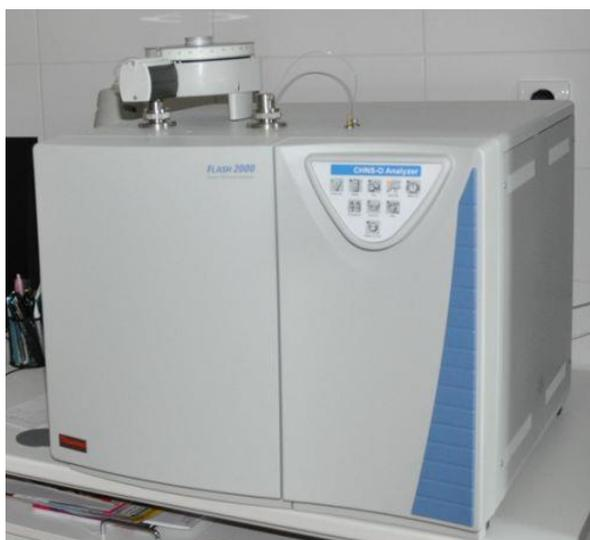
**Figura 12** - Analizzatore CHN (Flash EA 1112)
