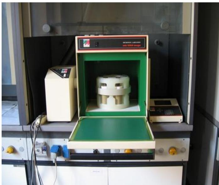
**Figura 9** - Mineralizzatore a microonde 1200 Mega Milestone®
