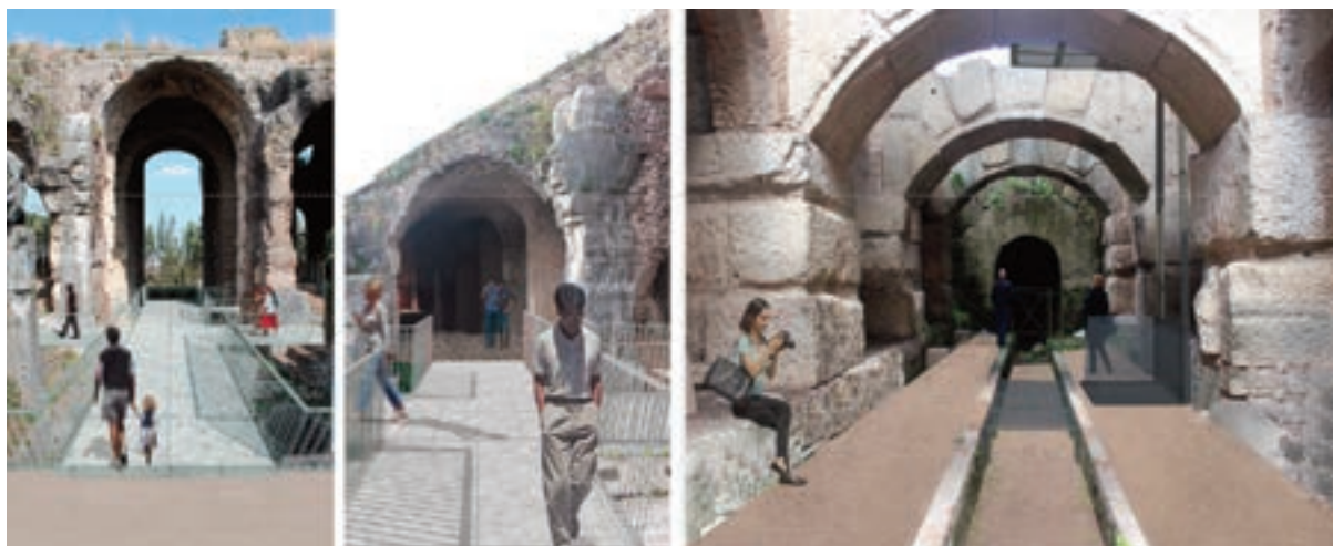
Figg. 13, 14 e 15. Render di progetto. Al piano terra: si rende percorribile l'intero giro dell'ellisse, collegando gli ambulacri con un tratto di pavimentazione dell'Anfiteatro. Al piano ipogeo: si rende accessibile con l'installazione di un ascensore e tramite un nuovo percorso pavimentato.
