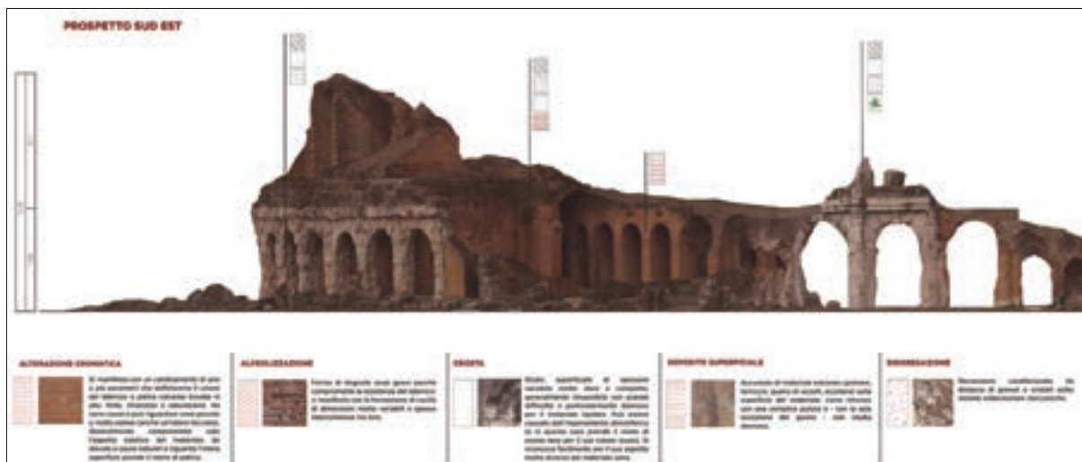
Fig. 11. Stato di fatto. Lettura delle criticità conservative mediante il Lessico NorMaL 1/88. Alterazioni macroscopiche dei materiali lapidei.
