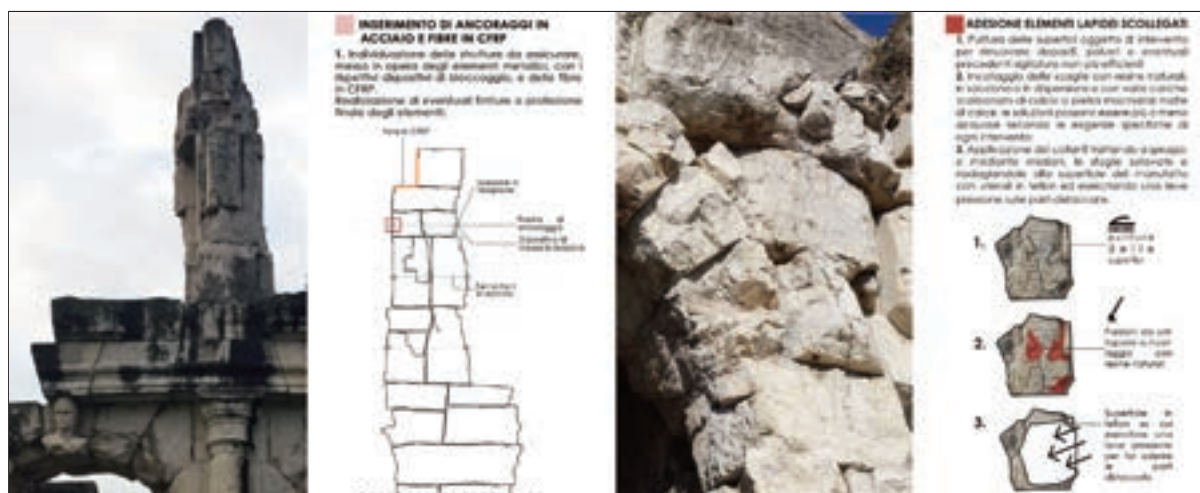
Fig. 12. Dalle schede operative di dettaglio dei singoli interventi da prevedere con la localizzazione e l'individuazione delle fasi di intervento per il consolidamento e la messa in sicurezza: l'inserimento di ancoraggi in acciaio e fibre in CFRP per gli elementi strutturali puntuali isolati e la risoluzione delle forme di degrado superficiali (2019).
