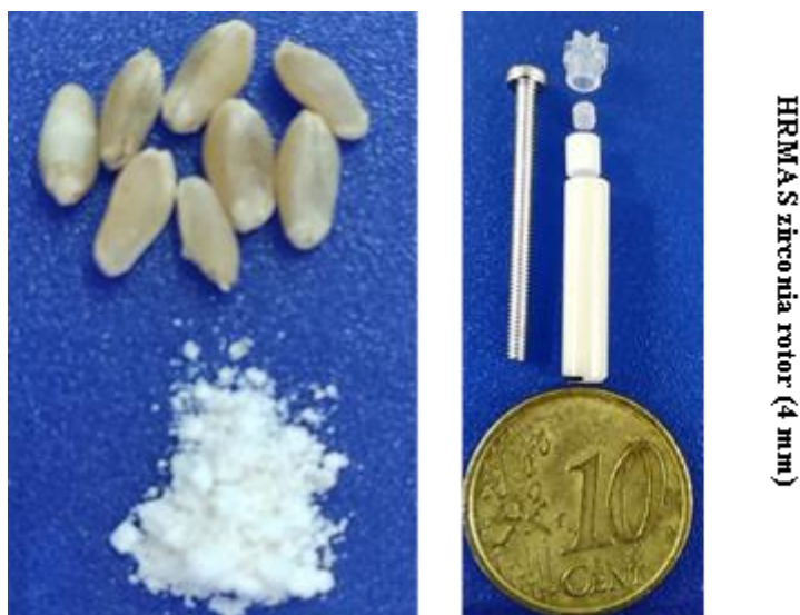
Figura 3.1 - Preparazione del campione per analisi HR-MAS NMR con evidenza su rotore e sue componenti (inserto forato in Teflon, vite di chiusura e tappo in Kel-F).
