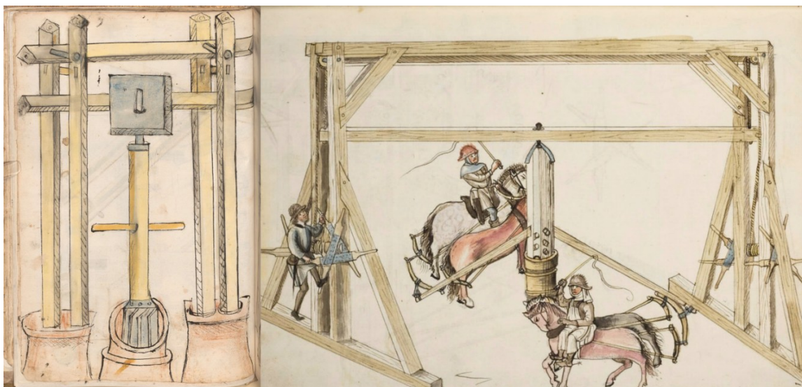
1. A sinistra, l'alesatrice verticale manuale del Liber machinarum . 2. A destra, un'alesatrice a trazione animale dotata di argani per la regolazione della profondità di taglio.
