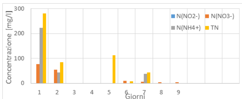
Figura 4.16 -Concentrazioni di azoto nitrico, azoto nitroso, azoto ammoniacale e azoto totale in nitrificazione per HRT=40 giorni eseguito per 10 giorni con 300ml/giorno diluizione 1:10
